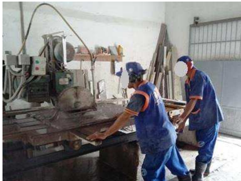
Figura 27 – Postura e movimentos inadequados na utilização da máquina de corte
