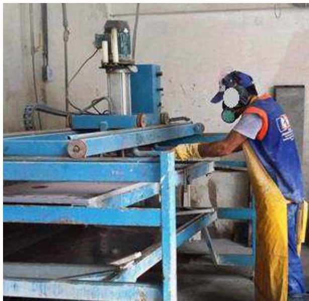
Figura 31 – Processo de acabamento de boca de pia
