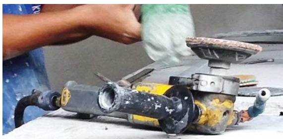
Figura 35 – ausência de proteção no disco da lixadeira politriz
