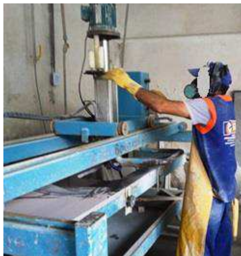
Figura 34 – Falta de proteção contra respingos de água na máquina de boca de pia
