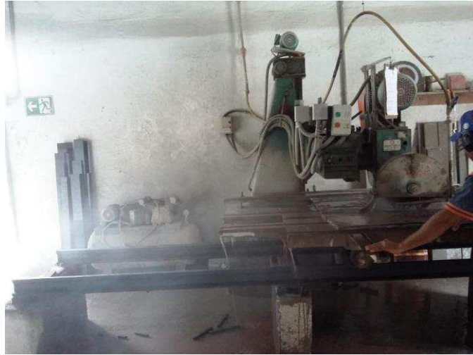
Figura 33 – Falta de proteção adequada na máquina de corte
