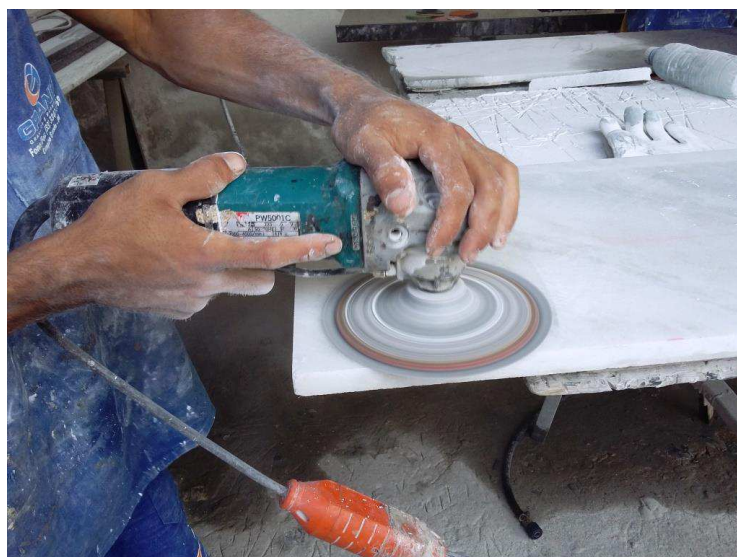
Figura 17 – Geração de poeira no processo de polimento do material
