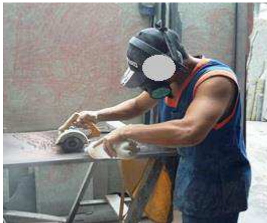
Figura 29 – Manuseio da serra mármore e posturas inadequadas no desbaste de boca de pia
