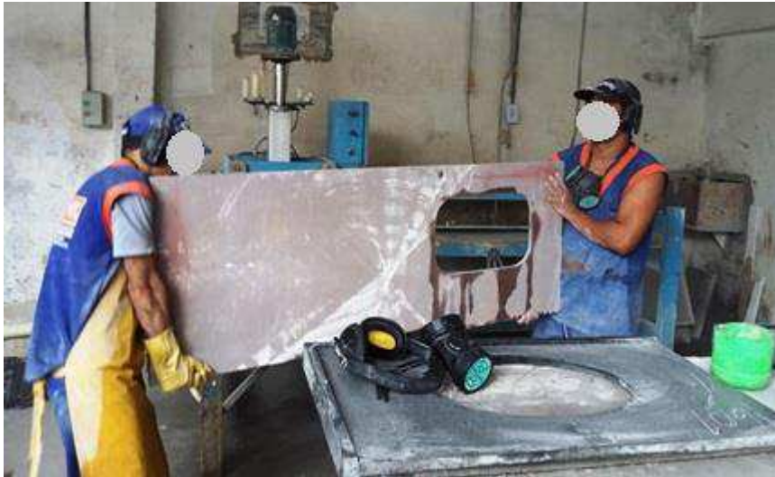
Figura 30 – Transporte inadequado da bancada para a máquina de boca de pia
