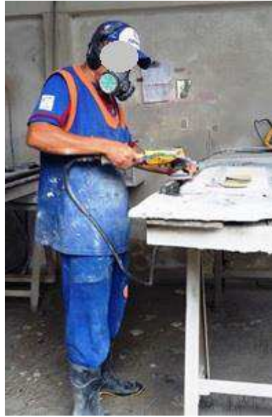
Figura 28 – Acabamento manual na utilização da lixadeira politriz pneumática
