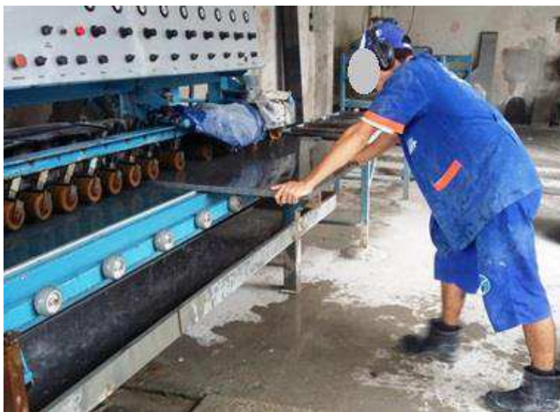
Figura 32 – Falta de proteção na máquina contra os respingos da água reutilizada no processo
