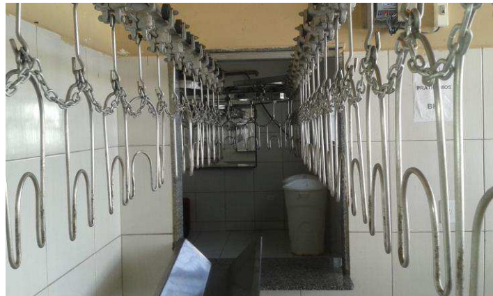
Figura 8: Nória, equipamento que os frangos são pendurados para passar pelo processo de sangria e escaldagem
