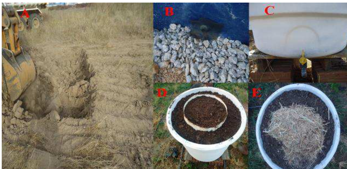
Figura 3. Ilustração da área de coleta do solo para o preenchimento dos lisímetro (A), da camada de brita e areia grossa (B), saída do dreno (C), do enchimento dos lisímetro com o cilindro ao centro (D), da cobertura com palha de milho triturada (E), CCTA/UFCG, Pombal-PB, 2016.
