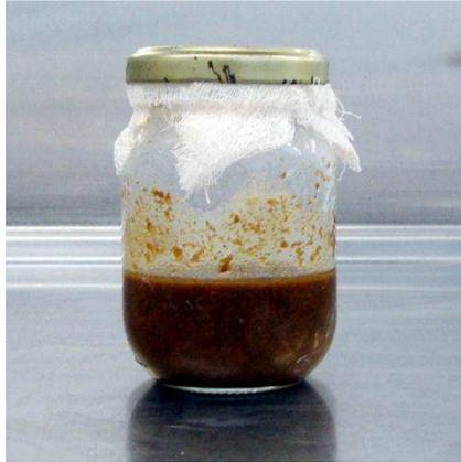
Fotografia 7 – Pote, após esterilização, contendo 30 g do substrato suplementado com farinha de soja comercial e 75 mL de água destilada
