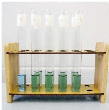
Fotografia 4 – Tubos de ensaio contendo 1 mL de água destilada (branco) e amostras dos ensaios experimentais 1, 2, 3, 4, 9, 10, 11 e 12 acrescidos de 4 mL da solução reagente Biureto
