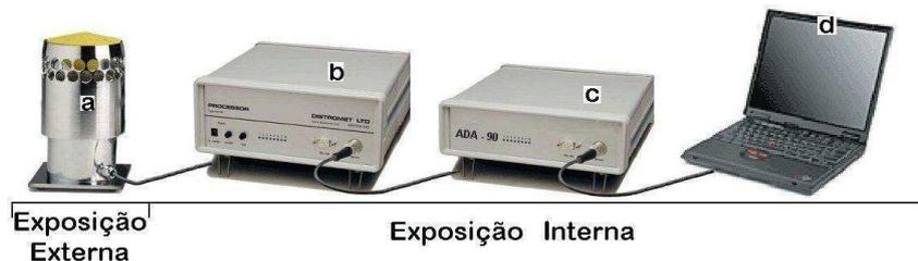
**Figura 3.1** – Ilustração do sistema de medição e avaliação de gotas de chuva.
