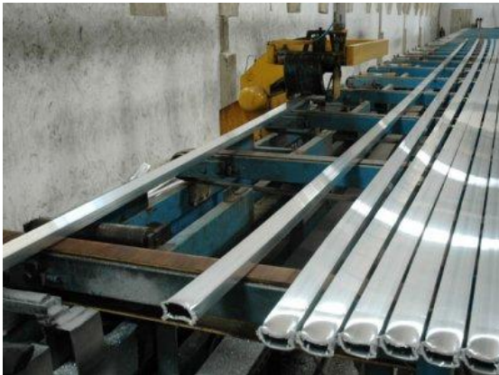
Figura 7: Robô realizando alinhamento do alumínio.
