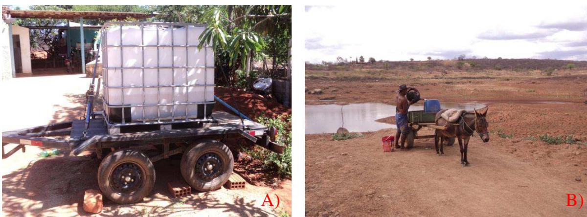
Figura 82- A) Reboque com caixa d'água de 1.100 L e B) Carroças com burros utilizadas para transporte de água. Fonte: A autora (2016).
