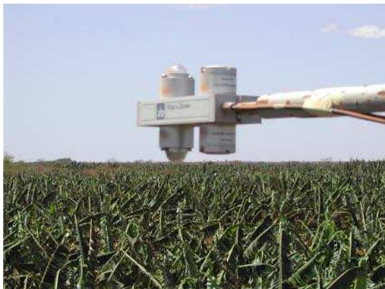
**Figura 9:** Saldo radiômetro modelo CNR1, instalado sobre a copa do bananal.
