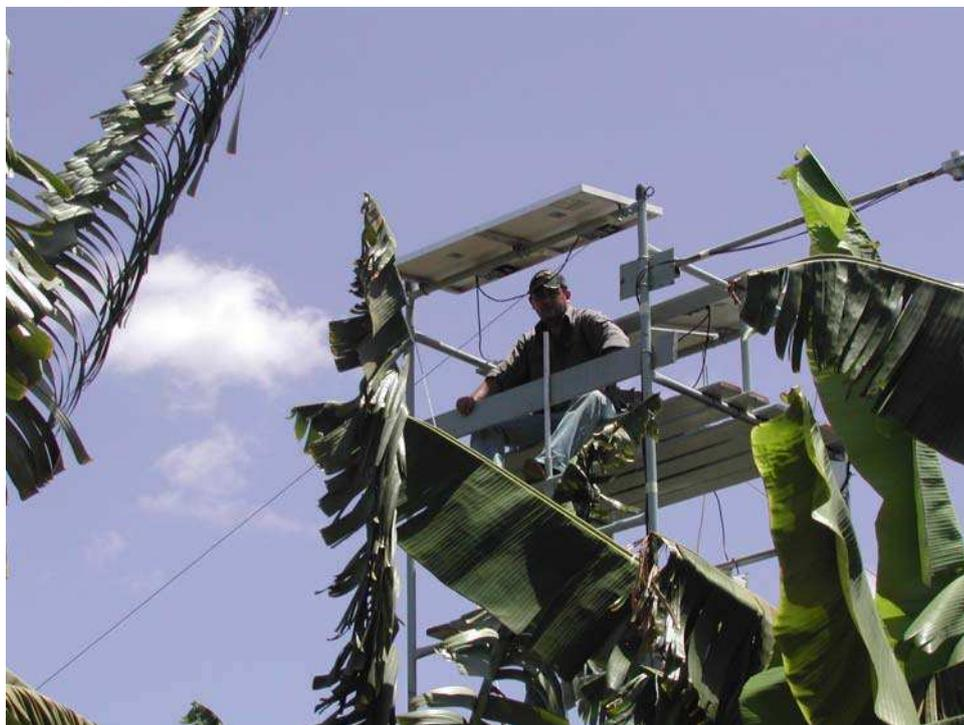
**Figura 5:** Torre micrometeorológica instalada no centro do pomar de bananeiras na Fazenda Frutacor, em Quixeré, Ceará.
