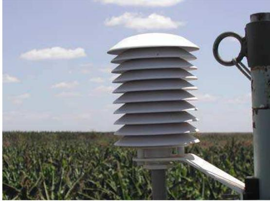
**Figura 7:** Sensor HMP45C, instalado sobre a copa do bananal.
