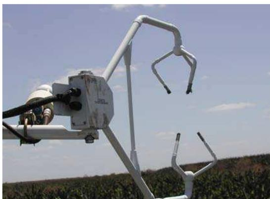
**Figura 6:** Anemômetro sônico 3D modelo CSAT3, instalado sobre a copa do bananal.
