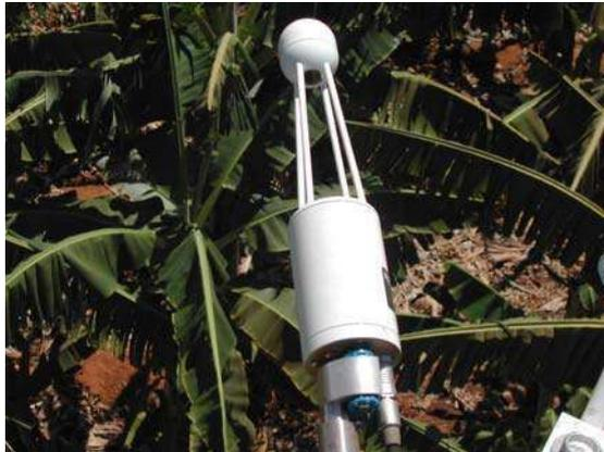
**Figura 8:** Analisador de CO<sub>2</sub>/H<sub>2</sub>O LI-7500, instalado sobre a copa do bananal.
