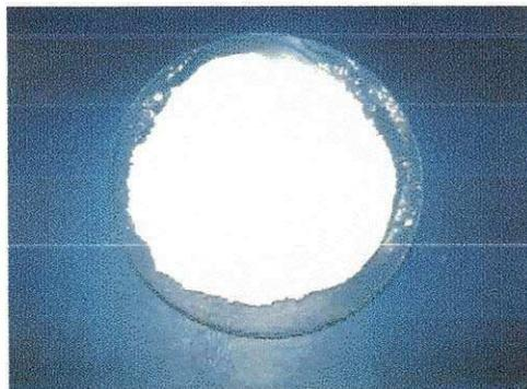
Figura 3.3: Amostras da argila esmectítica organofílica comercial importada Cloisite 30B.
