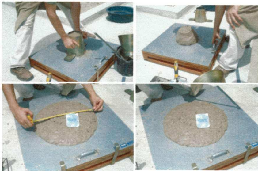
Figura 4.16: Ensaio de espalhamento com a mesa de Graff.
