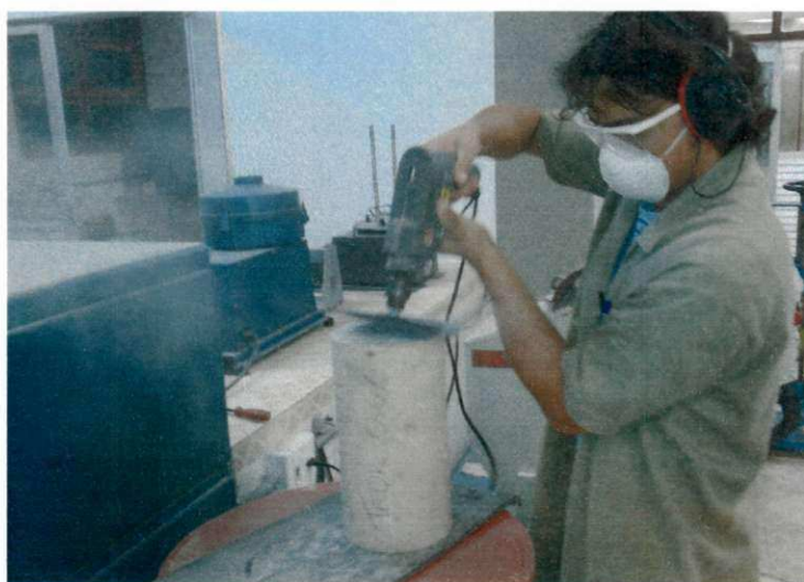
Figura 4.17: Correção das imperfeições por meio de lixamento da parte superior do corpo-de-prova.
