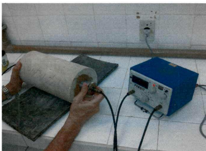
Figura 4.31: Ensaio de Ultra-sonografia para determinação do Módulo de Elasticidade em corpos-de-prova cilíndricos de 15cm x 30cm com j=28 dias.
