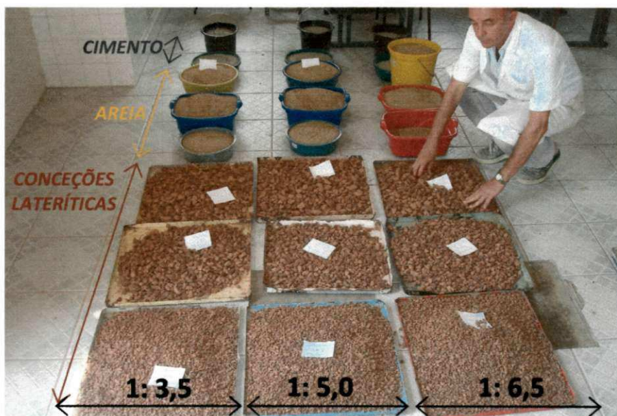
Figura 3.2: Materiais secos para os traços 1:3,5; 1:5,0 e 1:6,5 para a concretagem que produzirá o diagrama de dosagem.
