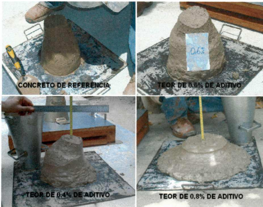
Figura 4.15: Abatimento do tronco de cone para o concreto de referência e teores de aditivos de 0,4%, 0,6% e 0,8%.
