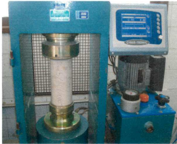
Figura 3.3: Ensaio de compressão no corpo-de-prova executado no Laboratório de Estruturas – UAEC - UFCG.
