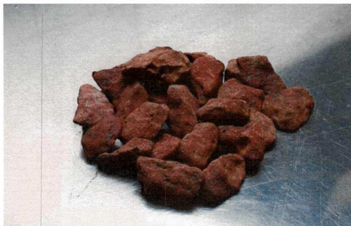
Figura 2.3: Concreções lateríticas (Fonte: Chagas Filho, 2005).
