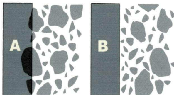
Figura 2.17: Ilustração do “efeito parede” na zona de transição. (Fonte: Scrivener, Crumbie & Laugesen, 2004).
