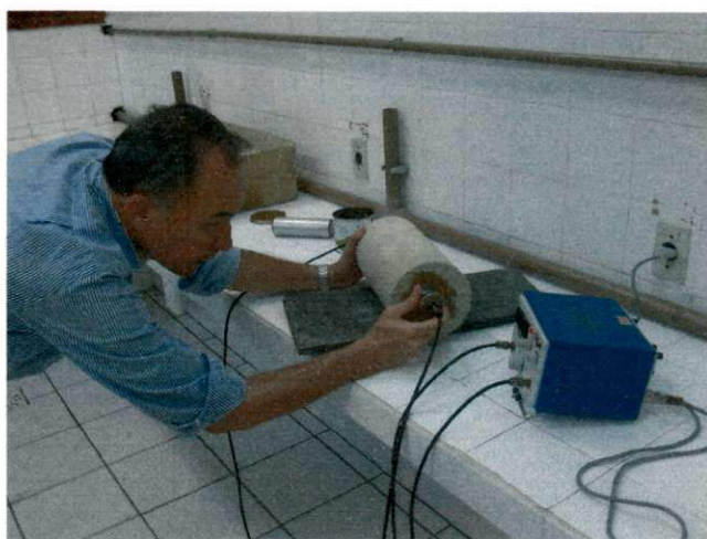
Figura 3.7: Ensaio de ultra-sonografia no corpo-de-prova cilíndrico com a utilização do PUNDIT no Laboratório de Estruturas – UAEC – UFCG.
