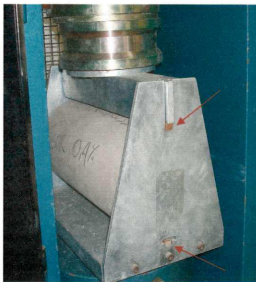
Figura 3.5: Corpo-de-prova no dispositivo para ensaio de tração indireta por compressão diametral no Laboratório de Estruturas – UAEC – UFCG.
