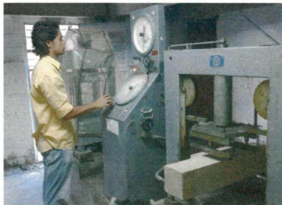
Figura 3.4: Ensaio de tração na flexão em corpo-de-prova prismático executado no Laboratório de Estruturas – UAEC – UFCG.
