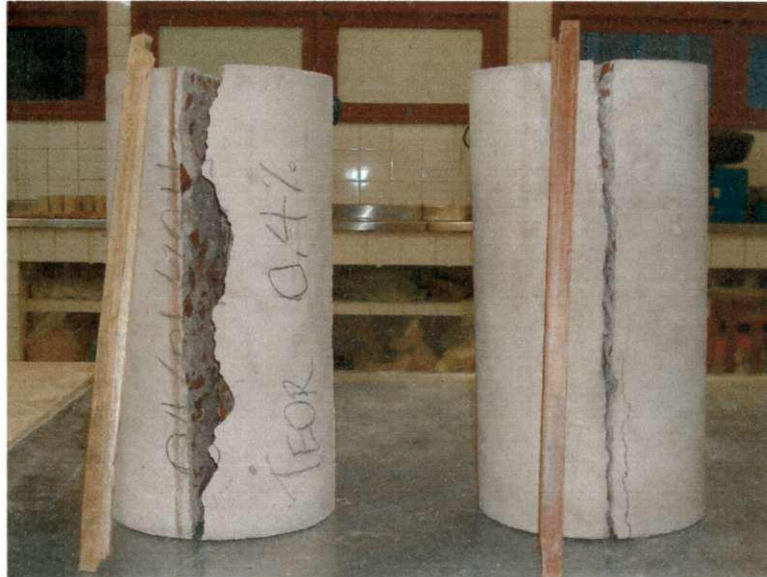
Figura 4.27: Influência da madeira no comportamento da fissuração dos corpos-de-prova no ensaio de tração indireta à compressão diametral: com talisca de Pinus Americano - à esquerda - e com Mogno - à direita.
