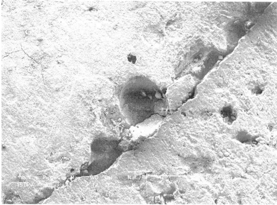
Figura 4.51: Fissura na interface com o agregado se propagando para bolha de ar e, em seguida, para a argamassa no concreto com 0,8% de aditivo, aos 3 dias de idade (43x).
