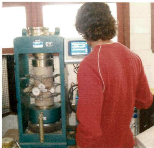
Figura 4.32: Verificação da deformação do concreto com compressômetro-expansômetro.
