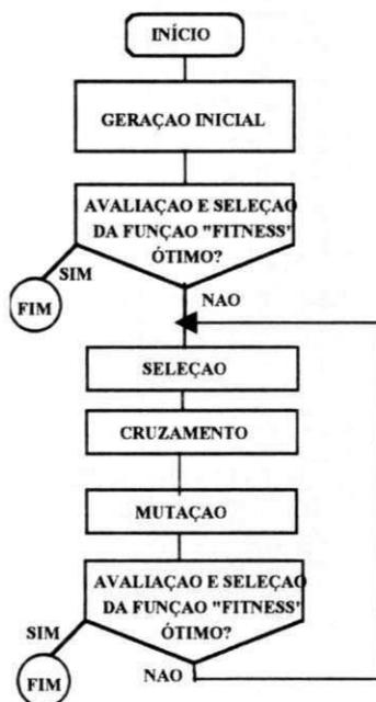
**Figura 3.4. Fluxograma do Algoritmo Genético.**
