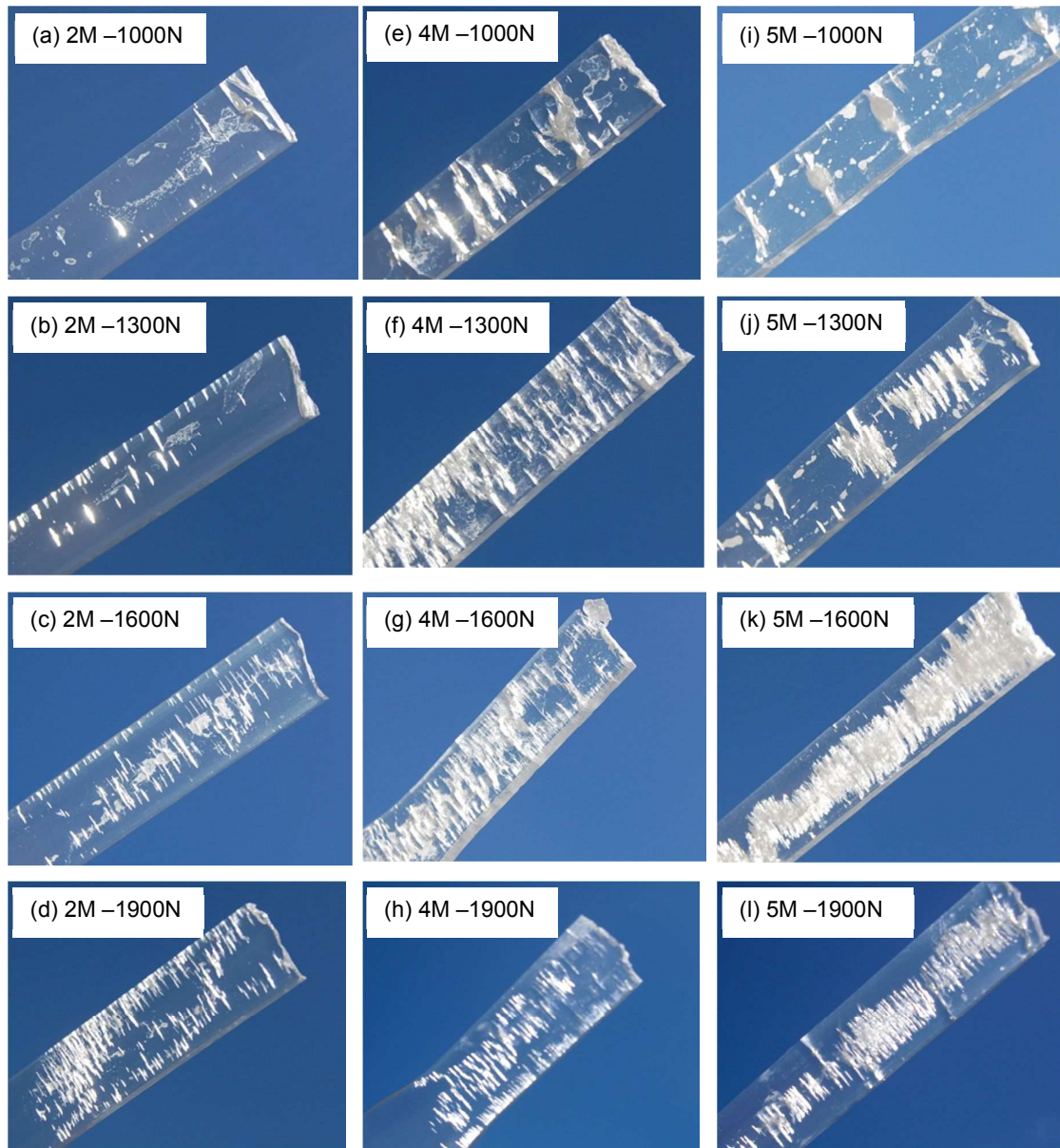
Figura 5.15 – Fotografias de corpos de prova de PET ensaiados por relaxação de tensão em diferentes forças e em contato com soluções aquosas de NaOH nas concentrações de 2, 4 e 5M.
