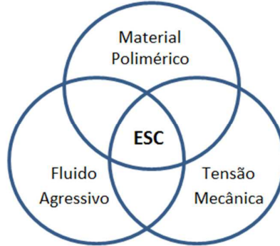
Figura 3.1 – Elementos necessários para ocorrer falha por ESC.
