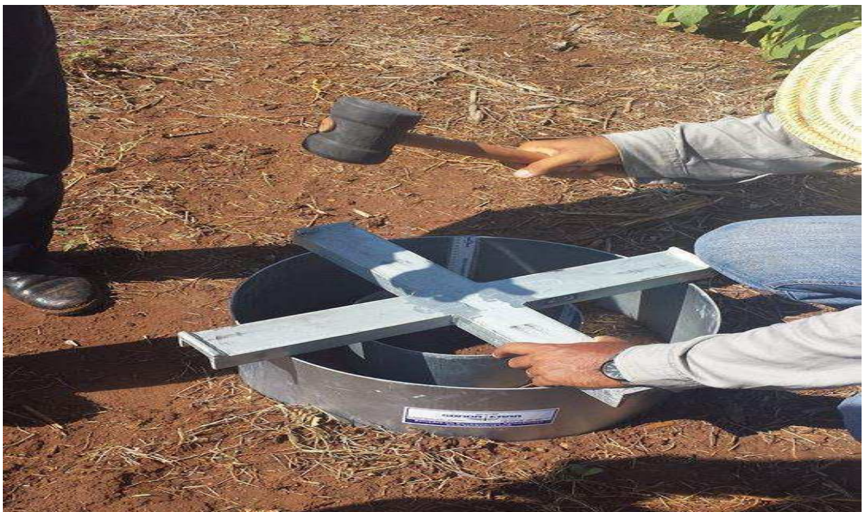
Figura 3.10 - Infiltrômetro instalado na área experimental. Apodi, RN, 2015
