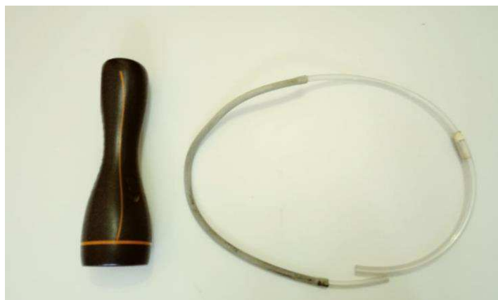
Fig. 6. Lanterna e Capturador de Castro utilizados nas capturas, pela equipe de campo da Vigilância em Saúde Ambiental.
