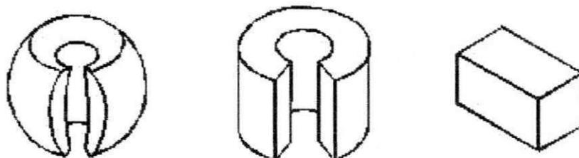
**Figura 2.2 – Espaços de trabalho para algumas das anatomias de robô: Polar, Cilíndrico e Cartesiano respectivamente.**
