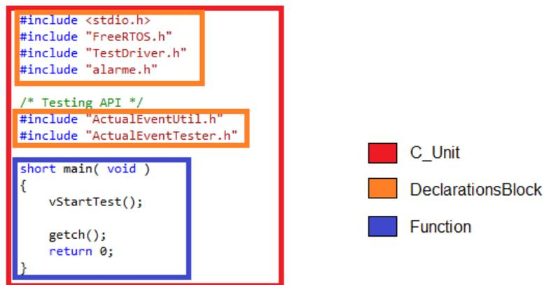
Figura E.3: Exemplo de instanciação de alguns elementos do pacote Main.
