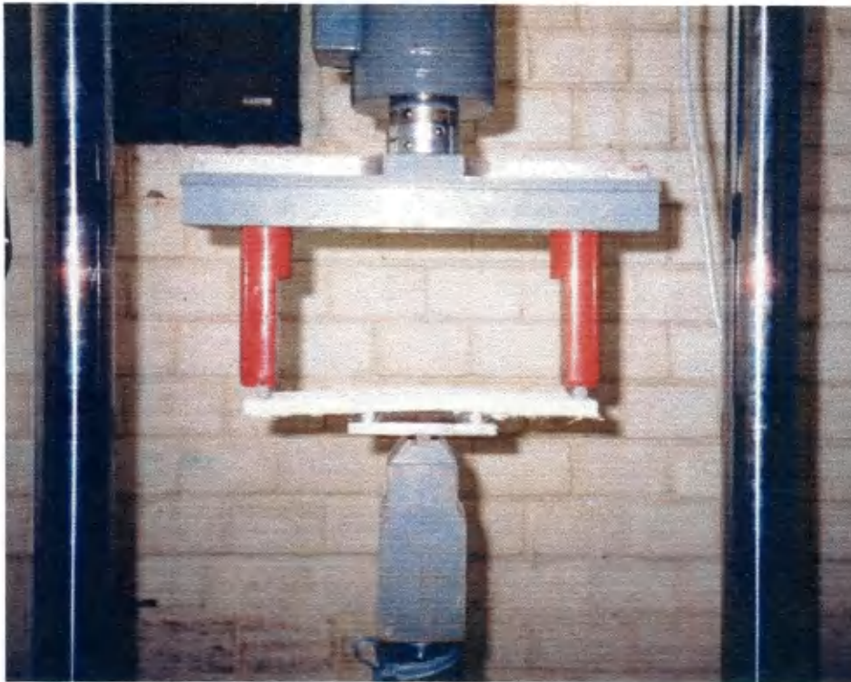
FIGURA 3.4: Corpo de prova sendo submetido ao ensaio de flexão na MTS
