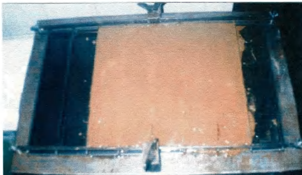
FIGURA 3.1: Molde utilizado na produção dos corpos-de-prova de flexão
