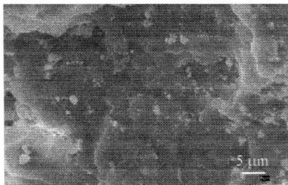
Figura 5.33 – Micrografia da superfície de fratura (em tração) da amostra poliéster/retardante de chama (5000X).
