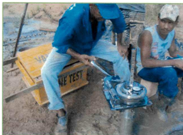
Figura 3.9 – Ensaio de palheta executado no Aterro 3.
