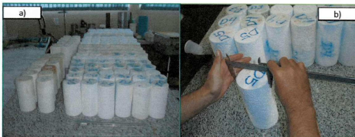
Figura 3.11 – Corpos de prova para ensaio de compressão: (a) organização dos grupos, (b) utilização de paquímetro.
