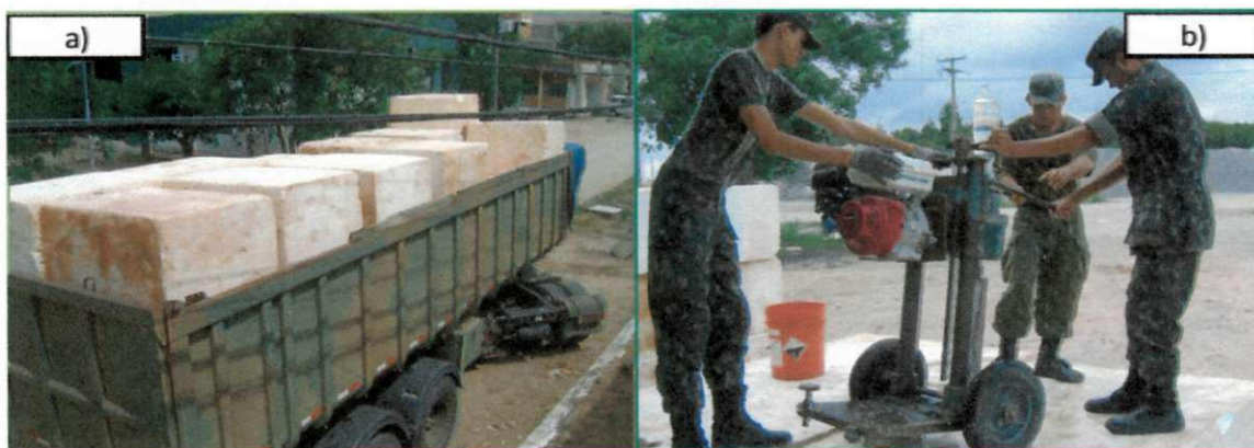
Figura 3.10 – Corpos de prova de EPS: (a) transporte, (b) extração.
