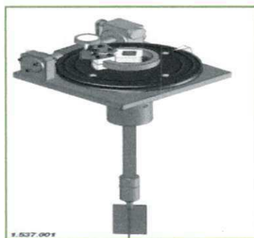
Figura 3.7 – Equipamento para realização do ensaio de "Vane Test" (Manual Solotest, 2012).
