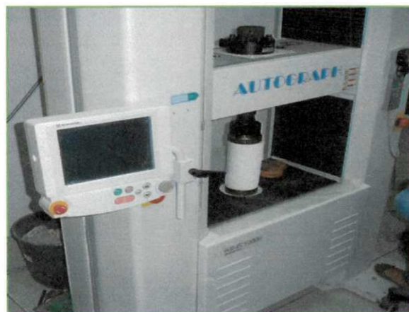
Figura 3.12 – Corpo de prova na prensa para realização do ensaio de compressão.
