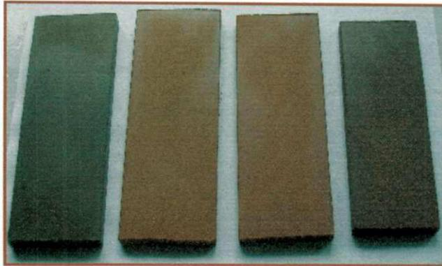
Figuras 4.9 – Corpos de prova prensados e sinterizados a 800°C, 900°C, 1000°C e 1100°C.
