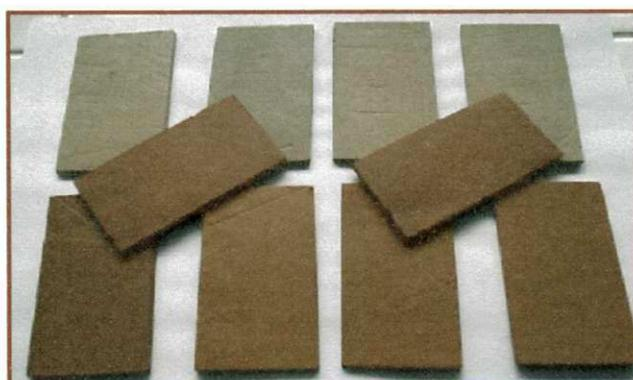
Figura 4.16-corpos de prova laminados secos a  $110^{\circ}\text{C}$  e sinterizados a  $1000^{\circ}\text{C}$
