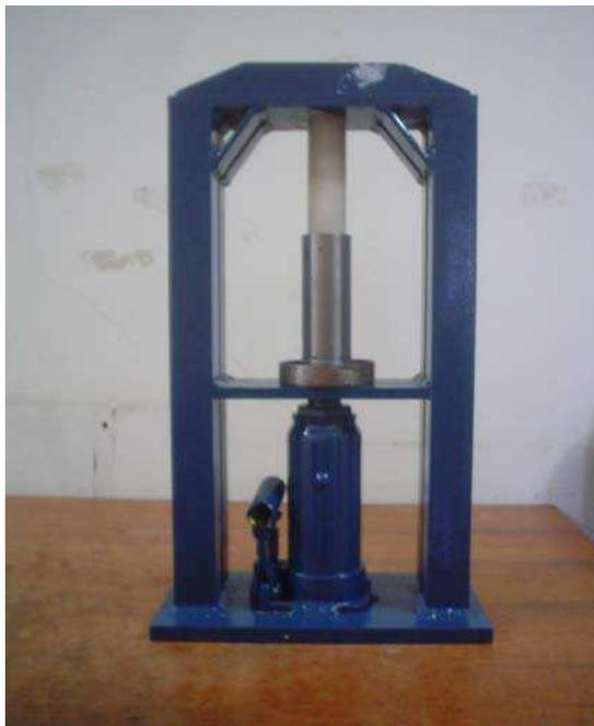
**Figura 2.** Protótipo da mini-prensa laboratorial.
