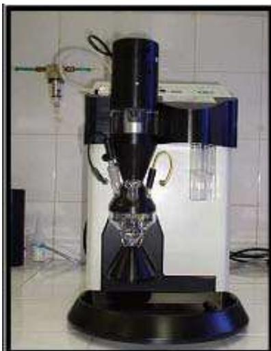
**Figura 7.** Polarógrafo modelo POL 150
