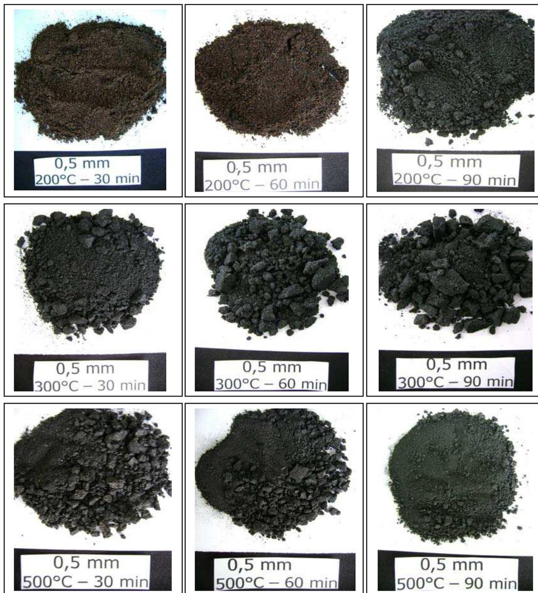
**Figura 6:** Amostras carbonizadas sob diferentes condições de temperatura e intervalos de tempo de aquecimento
