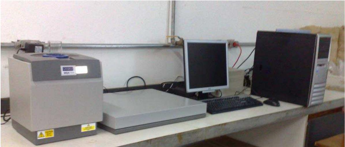
**Figura 4.** Espectrômetro de Ressonância Magnética Nuclear modelo MQA Oxford 7005
