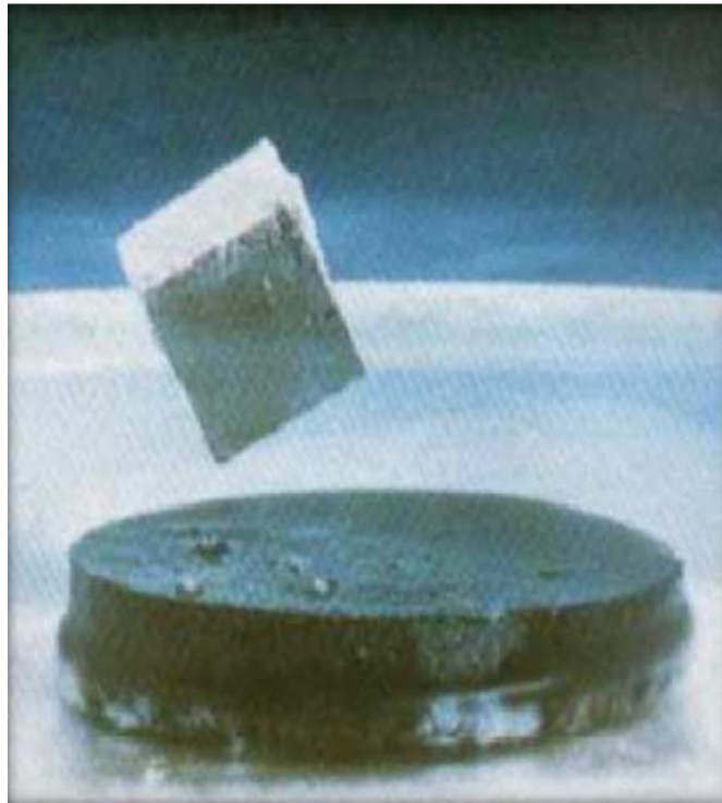
Figura 2.1: Levitação supercondutora devido ao efeito Meissner [6].
