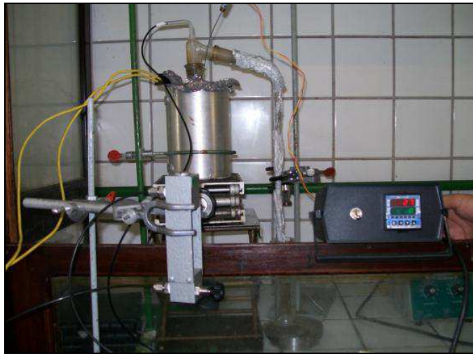
Figura 3.6 Sistema reacional com reator de vidro
