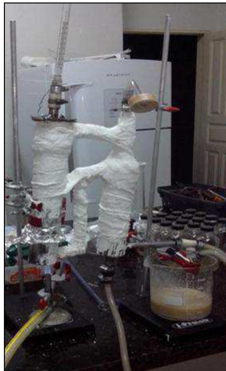
Figura 4.2 Reator com trocador de calor revestido com gaze embebida em cal hidratada
