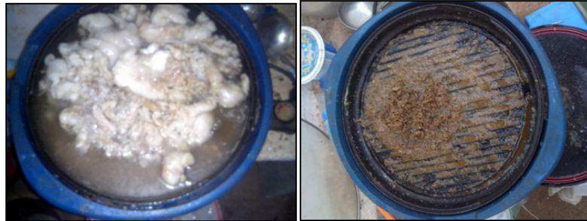
Figura 4.4 (A) Sebo In natura (bruto) sendo aquecido e (B) resíduo sólido
