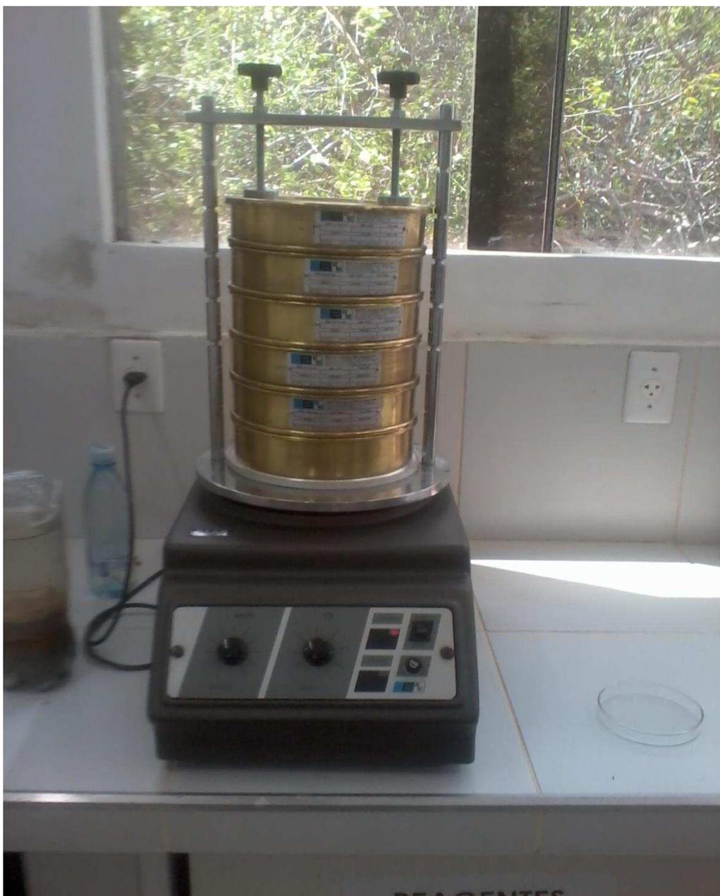
**Figura 06:** Peneiramento do sedimento utilizando-se máquina de “rot-up”.
