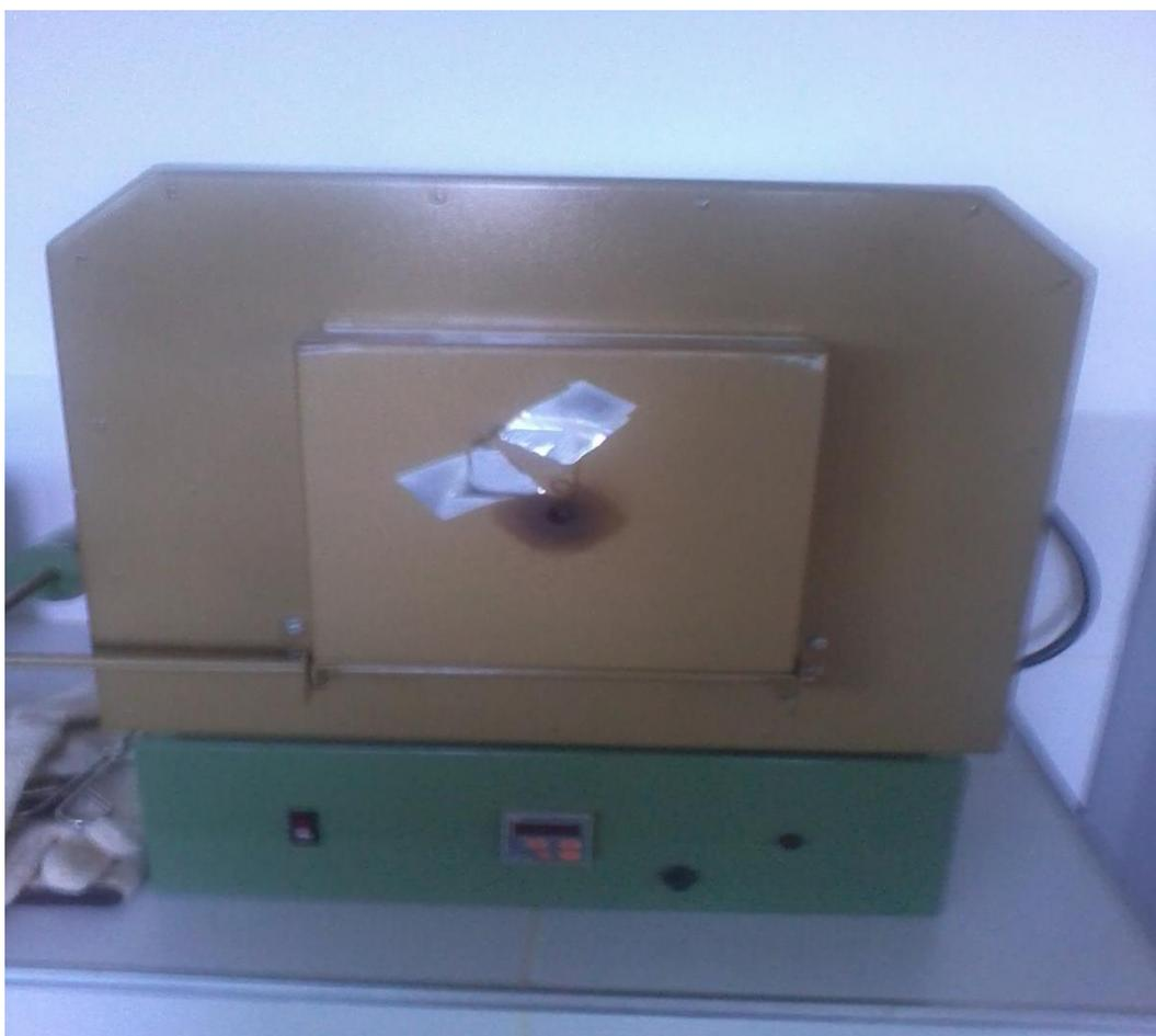
**Figura 07:** Mufla utilizada para obtenção do teor de matéria orgânica.
