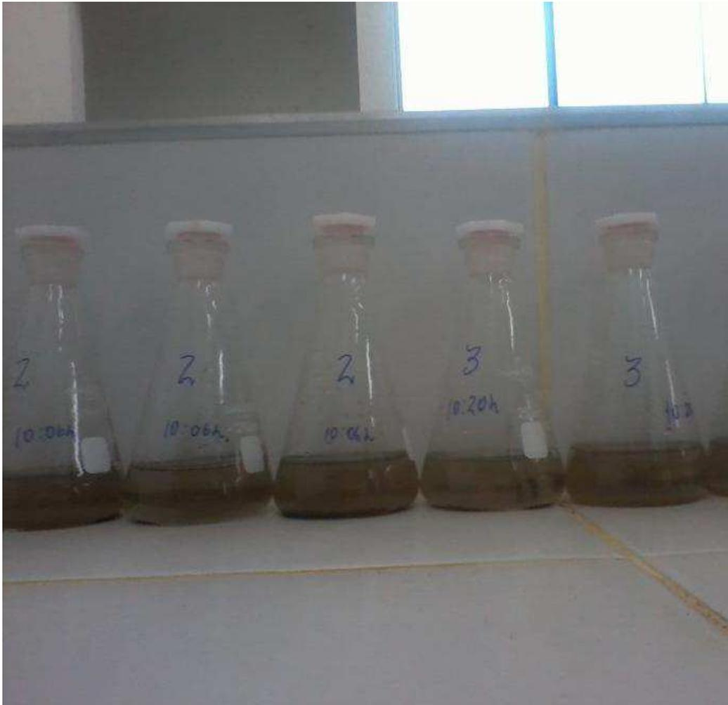
**Figura 12:** Amostras em decantação por 16 horas
