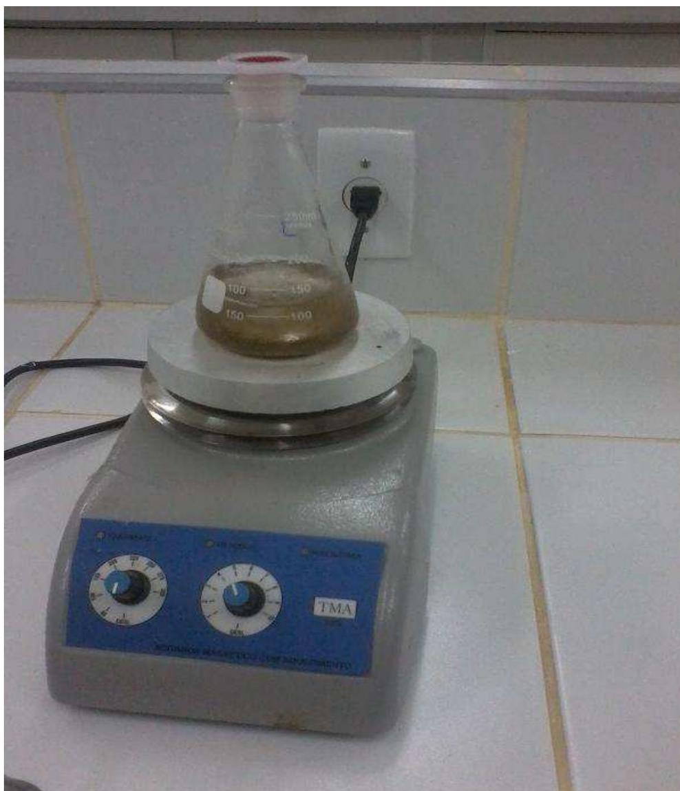
**Figura 11:** *Aparelho utilizado para agitação das amostras.*
