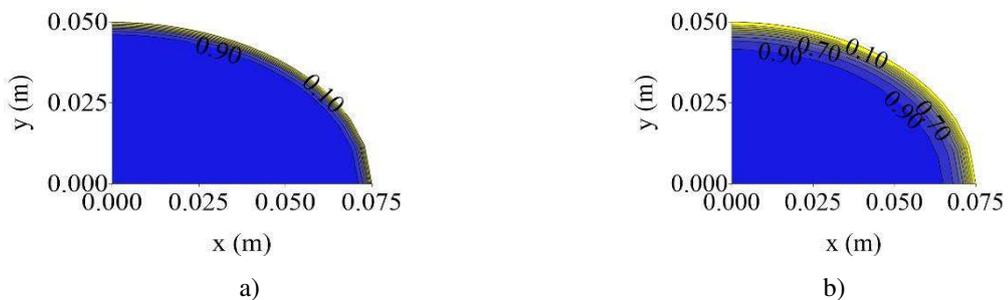
**Figura 4.37** - Distribuição de temperatura adimensional no interior do reator cilíndrico-elíptico em  $t = 3$  s ( $u_z = 0.2$  m/s): a)  $z = 0.00556$  m; b)  $x = z = 0.03889$  m.
