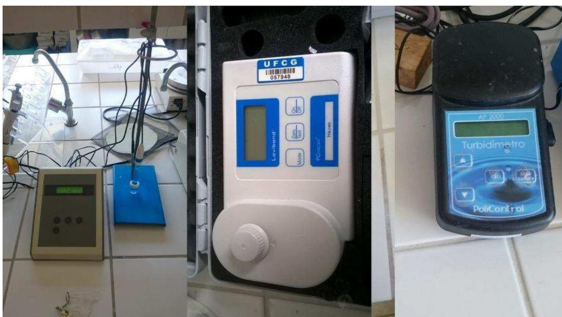
**Figura 1.** Medidores de pH, cor, turbidez e temperatura
