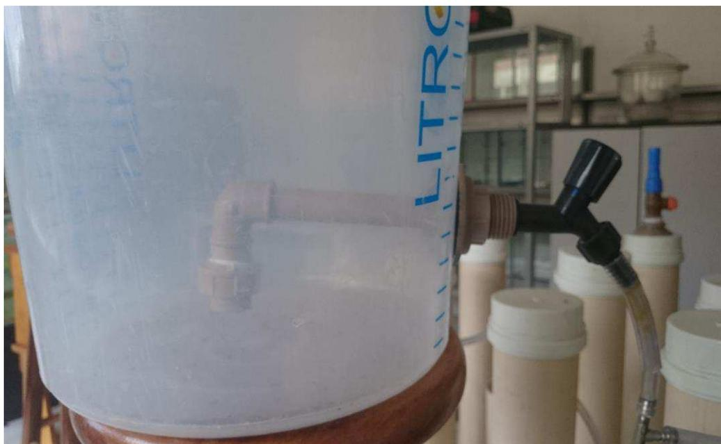
**Figura 7.** Saída de efluente modificada com proteção com tela
