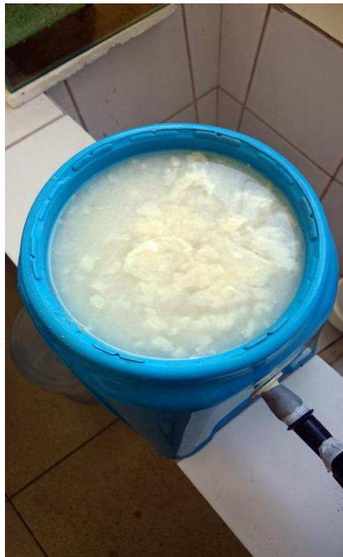
**Figura 4.** Saída de efluente entupida
