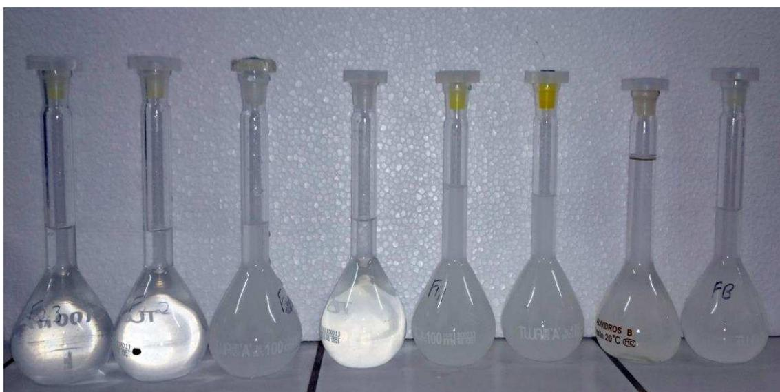
**Figura 2.** Preparação da amostra para DQO
