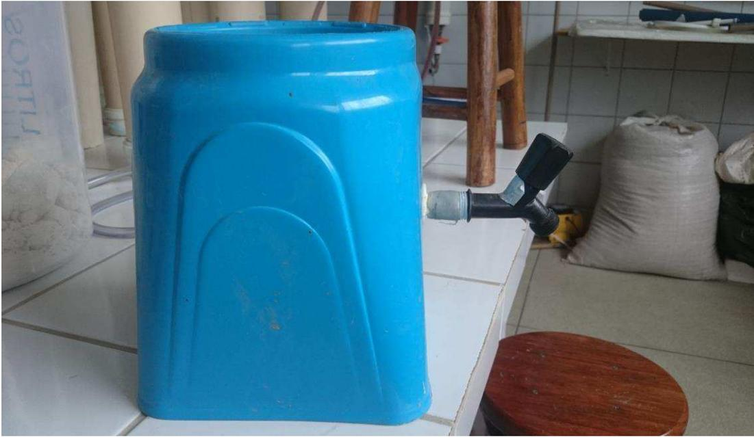
**Figura 3.** Dispositivo de saída de efluente para os filtros anaeróbios
