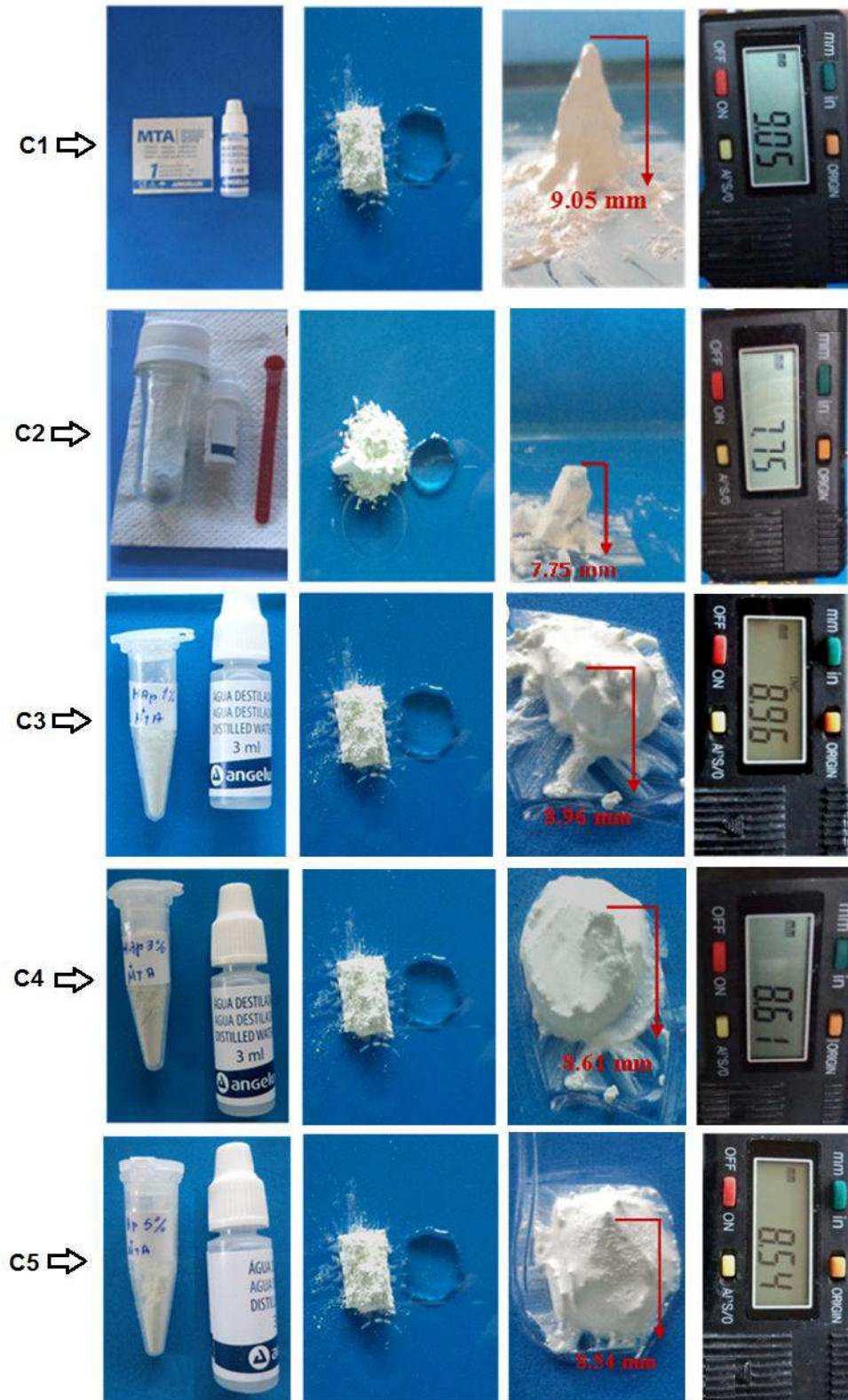
Figura 29: Consistência dos cimentos estudados evidenciando, da direita para a esquerda: o cimento e água destilada fornecida pelo fabricante, o momento da manipulação do cimento com a água destilada, o cimento após manipulação e endurecimento e a medida observada no paquímetro.
