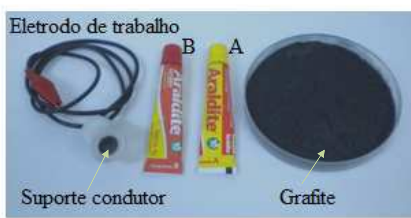
Figura 4.3 – Foto do eletrodo de trabalho com o suporte condutor e dos componentes (A, B e grafite) utilizados na preparação do suporte condutor.
