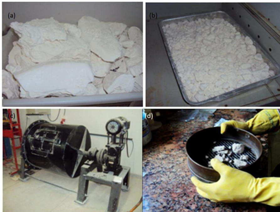
Figura 5: Beneficiamento do RCF(a): secado em estufa á 60°C(b); destorroado no moinho de bolas (c) e em seguida peneirado(d)
