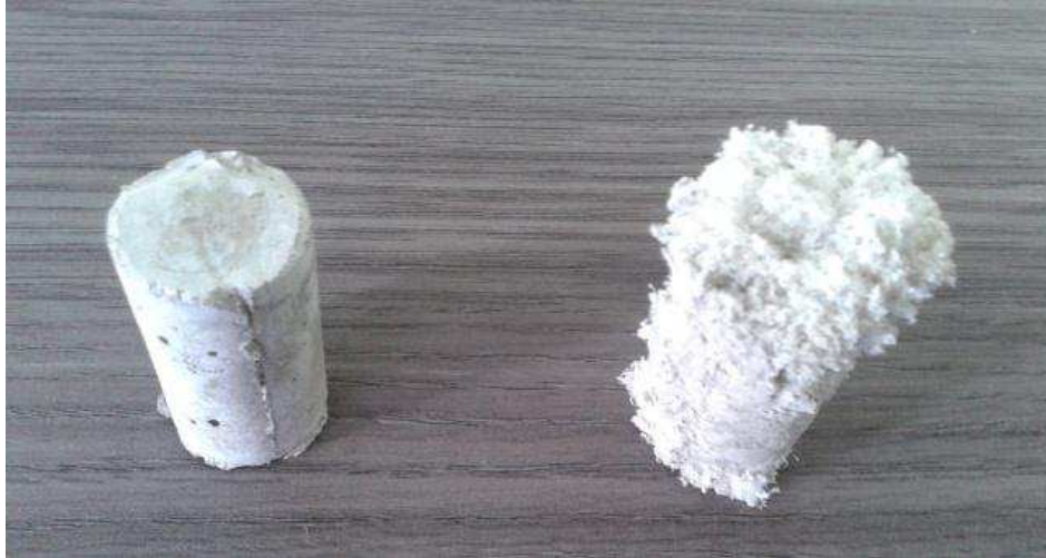
Figura 23: Progresso da eflorescência dos corpos de prova submetidos à cura à temperatura ambiente ao 1° e 10° dia de exposição.
