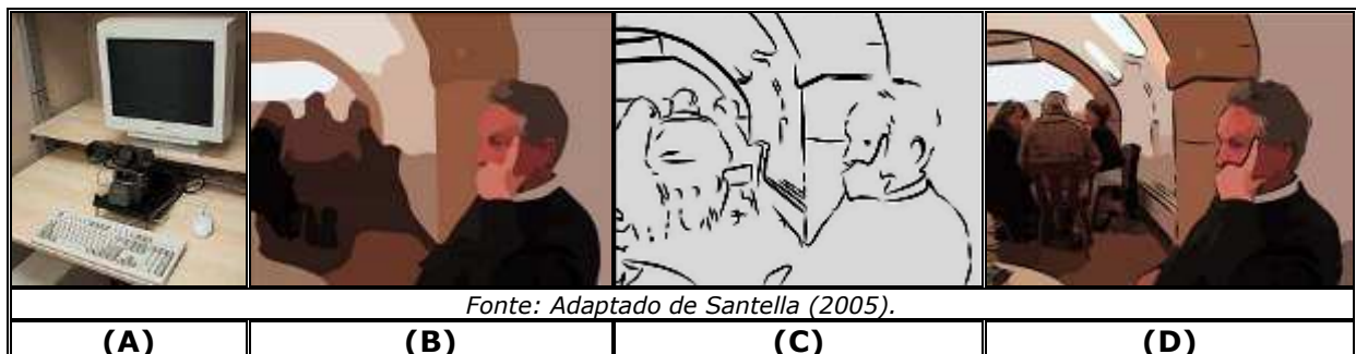
Figura 2.6 – Importância das bordas: (A) Aparato usado para rastreamento dos olhos; (B) Imagem segmentada sem bordas; (C) Bordas detectadas; e (D) Resultado final mais expressivo.
