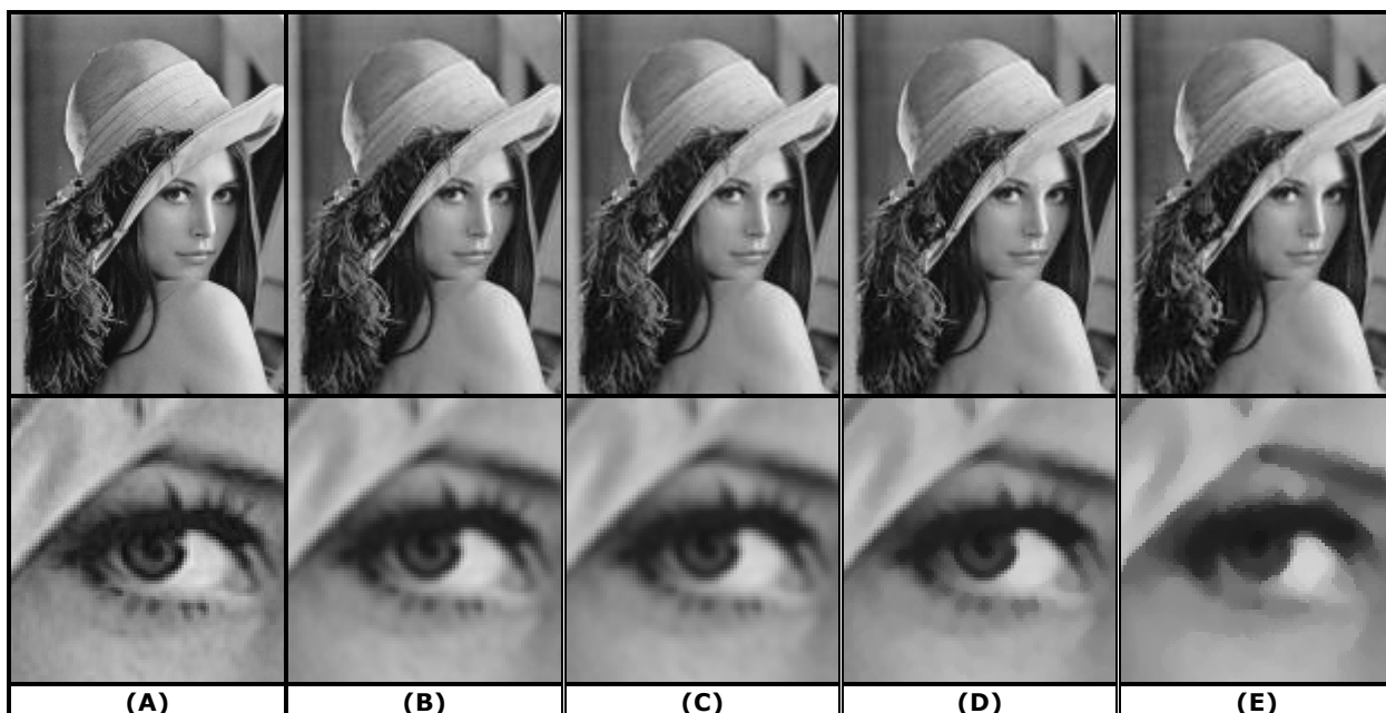
Figura A.9 – Suavização: (A) Original; (B) Gaussiana 3x3; (C) Gaussiana 5x5; (D) Duas iterações do filtro da mediana 5x5; e (E) Duas iterações do filtro da mediana 3x3.
