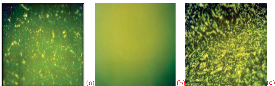
Figura 2.17 – Matriz asfáltica (a), matriz polimérica (b) e inversão de matrizes (c).
