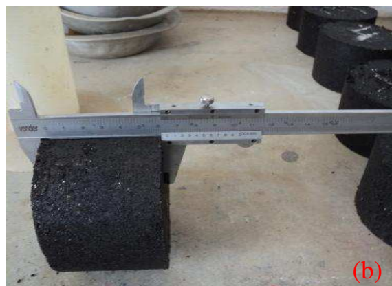
Figura 4.56. Etapa da aplicação dos 75 golpes em cada face dos CPs (a) e Medição com paquímetro dos CPs (b).
