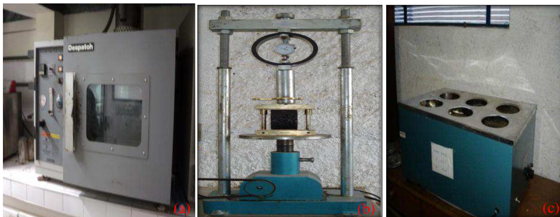
Figura 3.7 – Estufa RTFOT DESPATCH (a), pórtico de ruptura (b) e Banho Maria (c).
