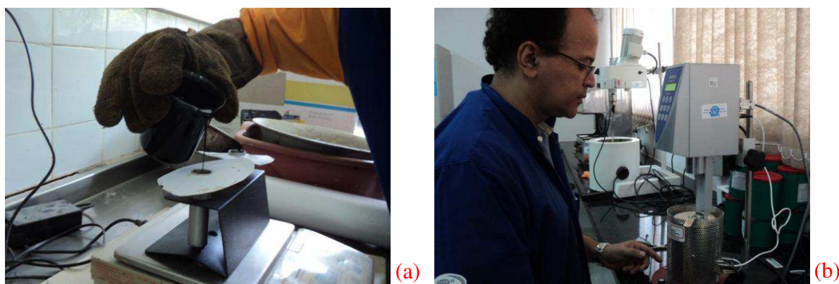
Figura 4.46. Preparação da amostra (a) e Análise no BROOKFIELD do ligante asfáltico modificado (b).
