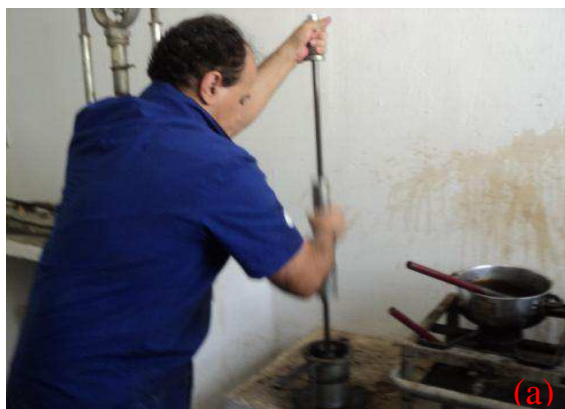
Figura 4.56. Etapa da aplicação dos 75 golpes em cada face dos CPs (a) e Medição com paquímetro dos CPs (b).
