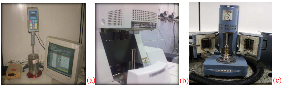
Figura 3.6 – Viscosímetro BROOKFIELD, Especificação: RVDV – II (a), Equipamento (DSC), Especificação: SHIMADZU, DSC ( Differential Scanning Calorimeter ) (b) e Equipamento (DSR), especificação: Advanced RHEOMETER AR 2000 (TA INSTRUMENTS) (c).
