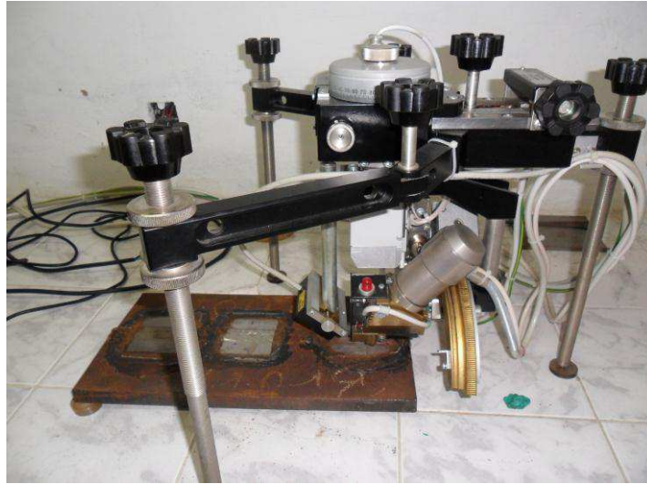
Figura 32: Difratorômetro com uma junta soldada posicionada para a determinação das tensões residuais transversais ao longo de uma determinada região.
