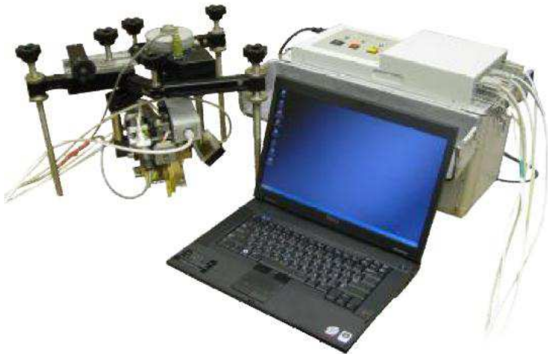
Figura 30: Difratorômetro portátil utilizado na análise de tensões residuais.
