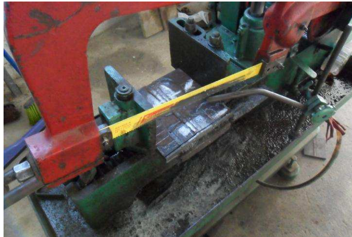
Figura 33: Obtenção de amostras da junta T3.0 para confecção de corpos de prova para testes de permeação eletroquímica de hidrogênio.
