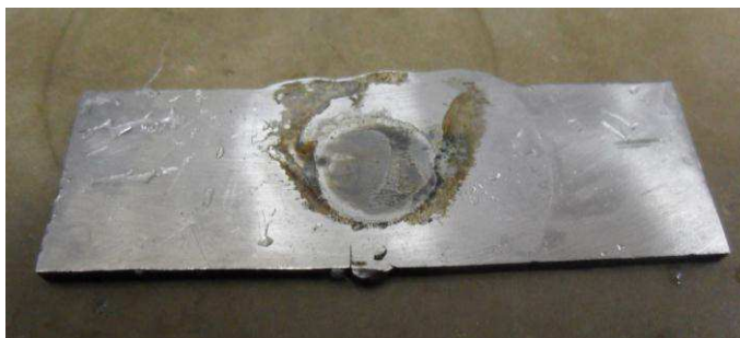
Figura 41: Região A da junta T2.0 após o teste de permeação.
