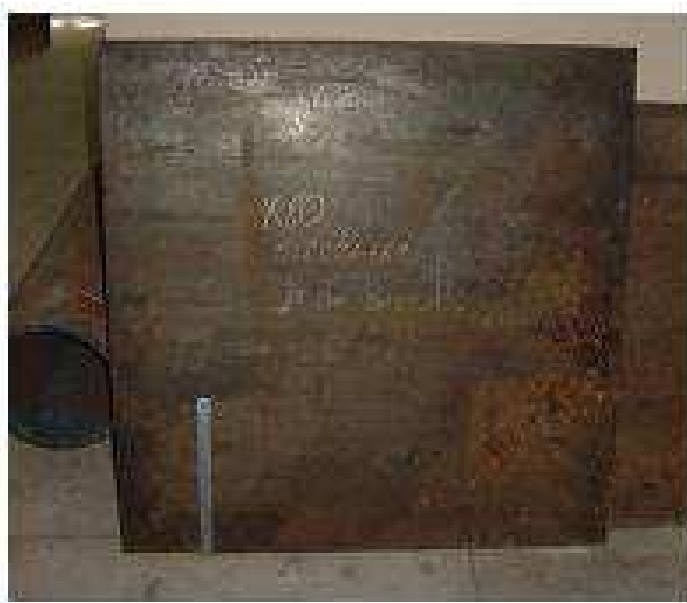
Figura 23: Chapa de aço API 5L X80 utilizada no presente trabalho.
