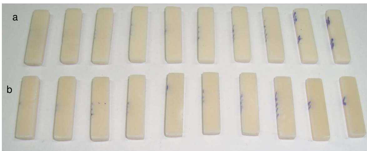
Figura 4.8- Corpos de prova sinterizados através de sinterização convencional (a) e através de energia de microondas (b).
