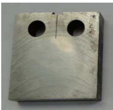
Figura 45. Corpo-de-prova de tração compacto utilizado nos ensaios de tenacidade à fratura ao ar.
