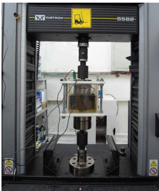
Figura 54. Máquina de ensaios de tração com célula de proteção catódica acoplada.
