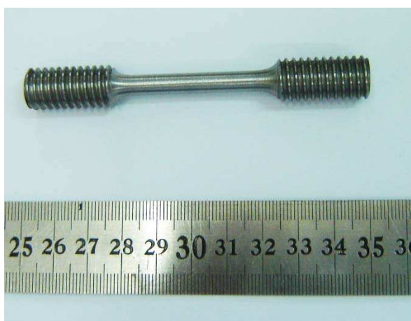
Figura 43. Corpo-de-prova E8M utilizado nos ensaios de tração.
