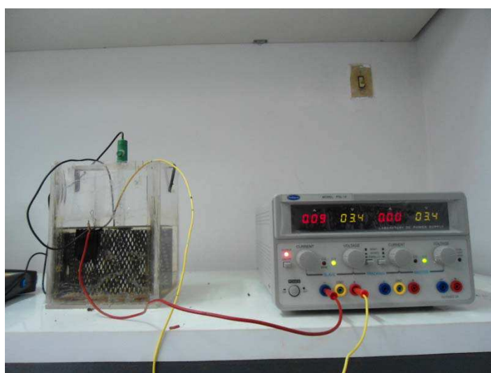
Figura 52. Célula de polarização catódica empregada no carregamento de hidrogênio nas amostras.
