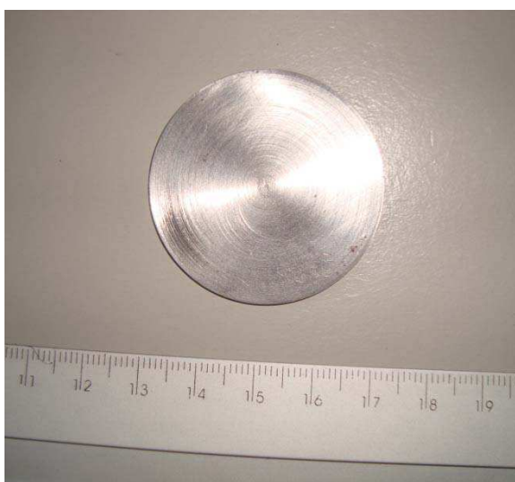
Figura 41. Membrana metálica utilizada nos ensaios de polarização potenciodinâmica e de permeação de hidrogênio.
