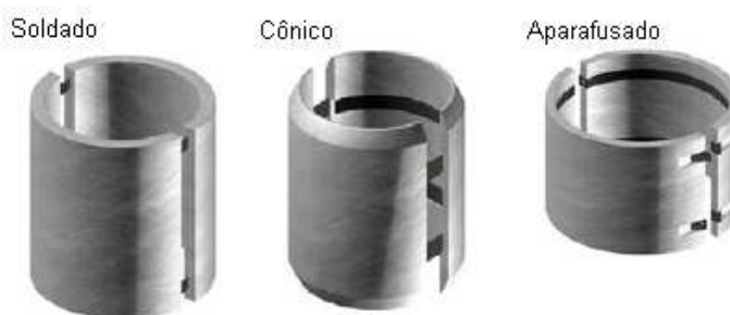
Figura 9. Ânodos de sacrifício tipo bracelete.
