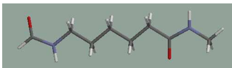
Figura 4: Estrutura molecular da poliamida6. Em azul, estão os átomos de nitrogênio; em vermelho, os oxigênios; em cinza, os carbonos e, em branco, os hidrogênios.
