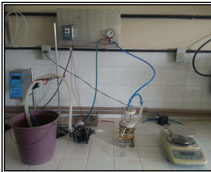
Figura 23: Célula de agitação acoplada a um sistema de filtração para coleta do permeado.
