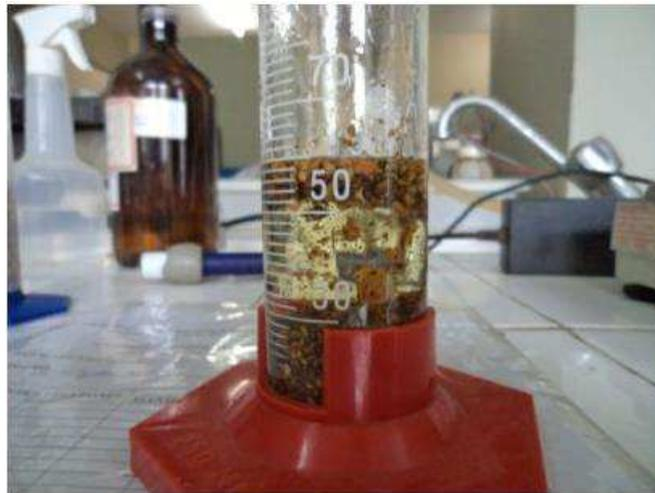
Figura 16– Determinação da densidade real
