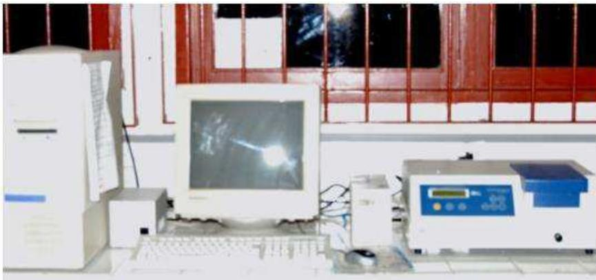
Figura 27 – Espectrofotômetro, utilizado para a leitura das absorvâncias das amostras
