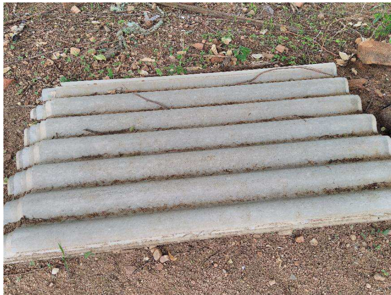
Foto 10: Telhas de amianto dispostas a céu aberto.
