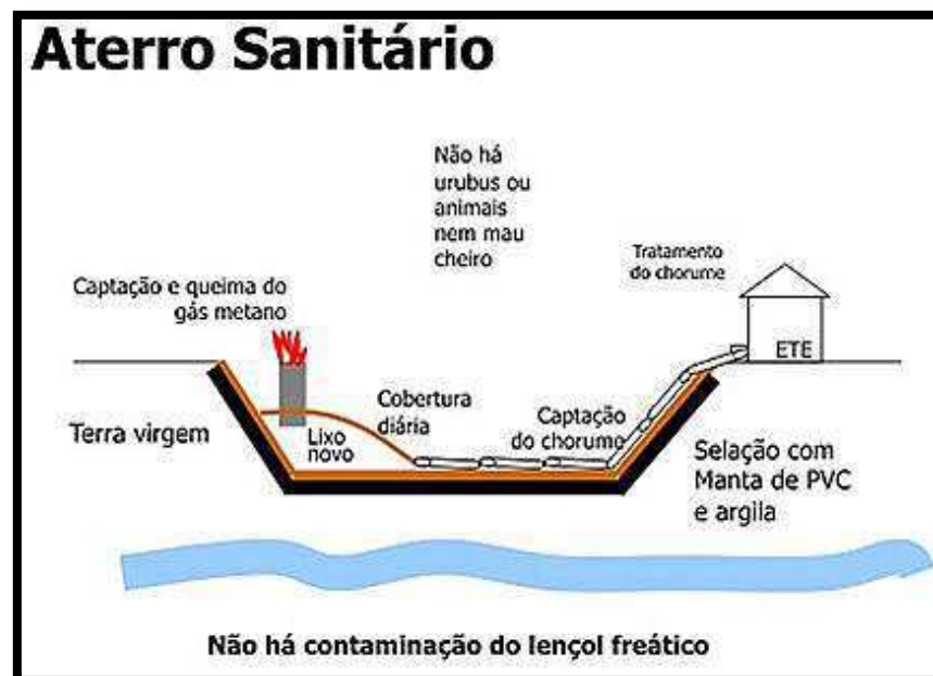
Ilustração 03: Esquema de como funciona um aterro sanitário.
