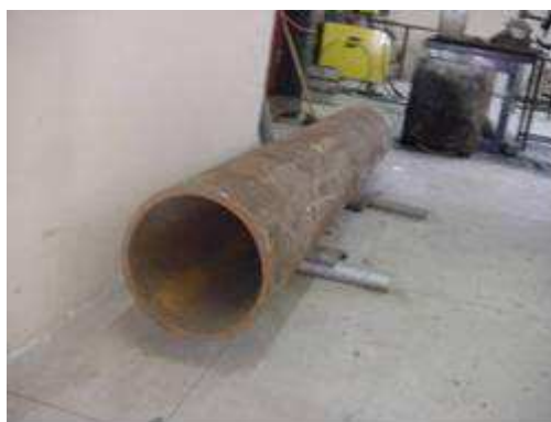
Figura 44: Tubo de aço API 5L Gr B na condição como-recebida.
