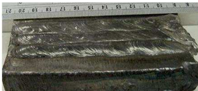
Figura 86: Aspecto típico dos revestimentos com três cordões.
