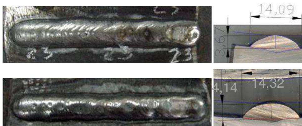
Figura 70: Cordões isolados aplicados pelo processo SAW com corrente pulsada.
