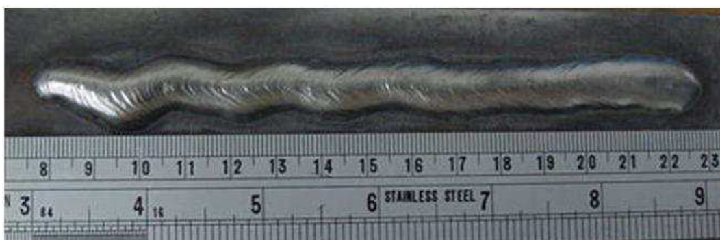
Figura 51: Cordão de solda não uniforme devido à utilização de DBCP acima de 30mm.
