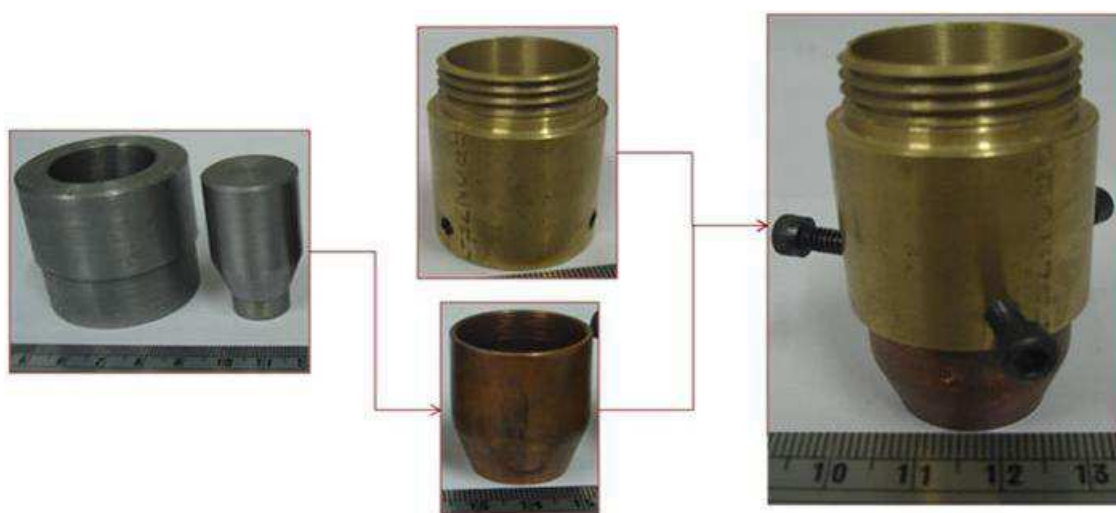
Figura 49: Dispositivo confeccionado para possibilitar soldagens com longo stickout.
