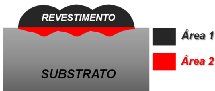
Figura 58: Metodologia para o cálculo da diluição de um revestimento com três cordões.
