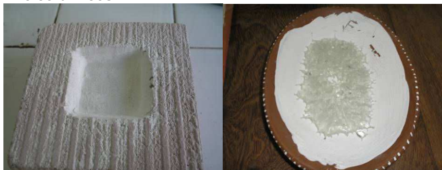
Figura 3.4 – Uso do caulim como desmoldante em moldes em concreto celular e cerâmicos
