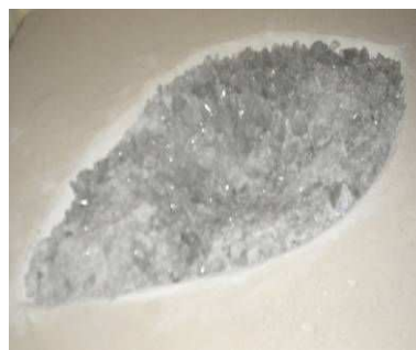
Figura 3.15 - Vidro triturado no molde
