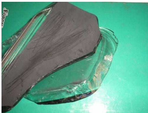
Figura 3.7 – Vidro da tela e do funil do monitor
