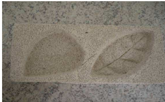
Figura 3.10 - Moldes em concreto celular para acomodação das amostras
