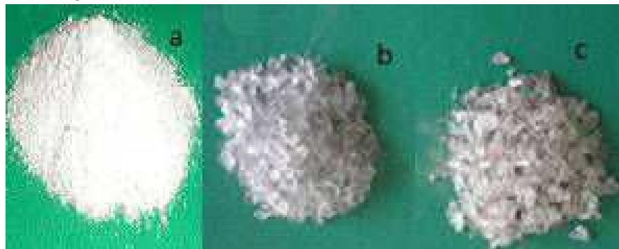
Figura 3.8 – Amostras peneiradas: (a) ABNT N° 200, (b) ABNT N° 40 e (c) ABNT N° 10
