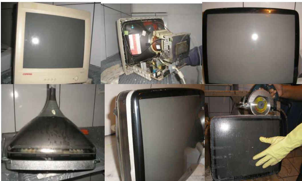
Figura 3.6 – Desmontagem do monitor
