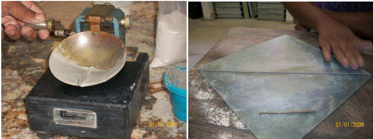
Figura 18- Determinação dos limites de liquidez (esquerda) e plasticidade (direita)
