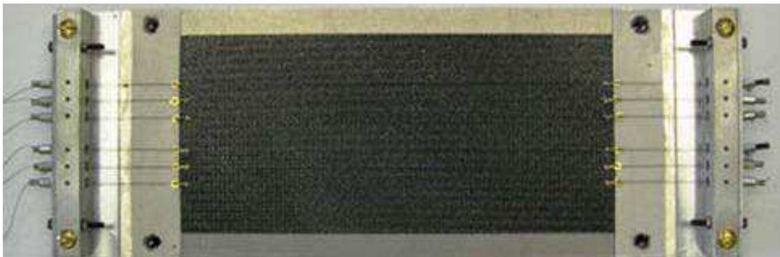
Figura 10: Molde para manter os fios LMF pré-deformados durante cura de um compósito. Bettini et al (2009).
