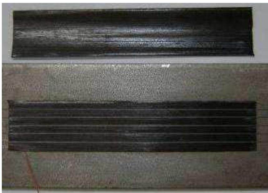
Figura 19: Montagem dos constituintes para fabricação dos compósitos CFRP-NiTi.
