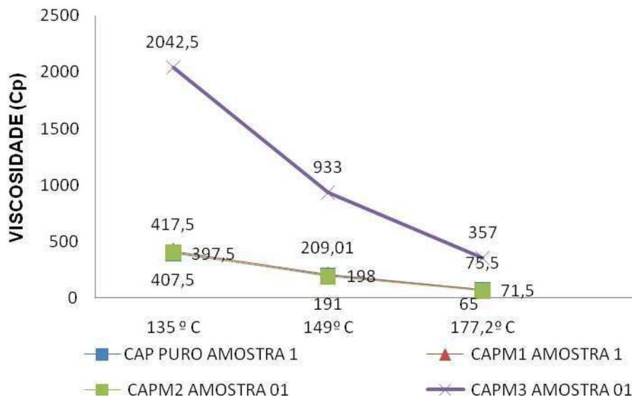
Figura 4.75. Variação da viscosidade em função da temperatura.
