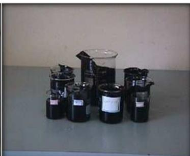
Figura 3.4. Amostra de CAP 50/70.
