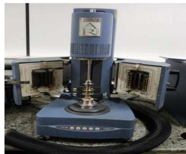
Figura 3.8. Equipamento (DSR). Especificação: *Advanced RHEOMETER AR 2000*. TA INSTRUMENTS. Fonte: Remy, 2013.
