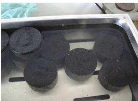
Figura 4.79 - Absorção d'água dos corpos de prova.
