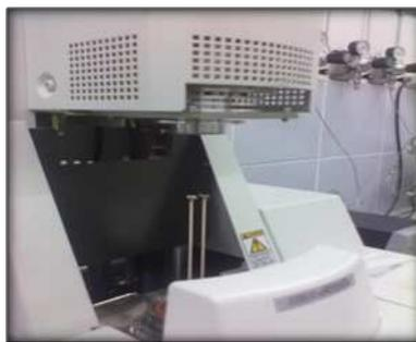
Figura 3.7. Equipamento (DSC). Especificação: SHIMADZU, DSC-60 *Differential Scanning Calorimeter*. Fonte: Remy, 2013.
