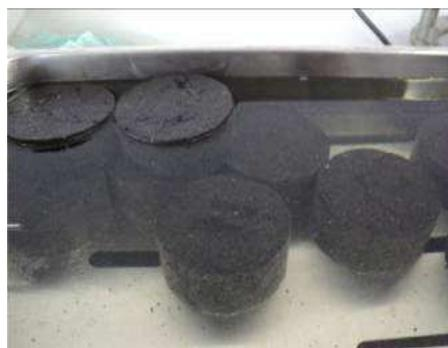
Figura 4.80 - Absorção d'água dos corpos de prova.
