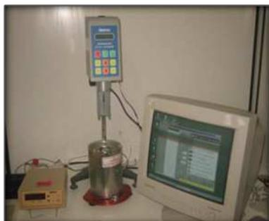
3.6. Figura. Viscosímetro *BROOKFIELD*, Especificação: RVDV – II. Fonte: Cambuim, 2004.
