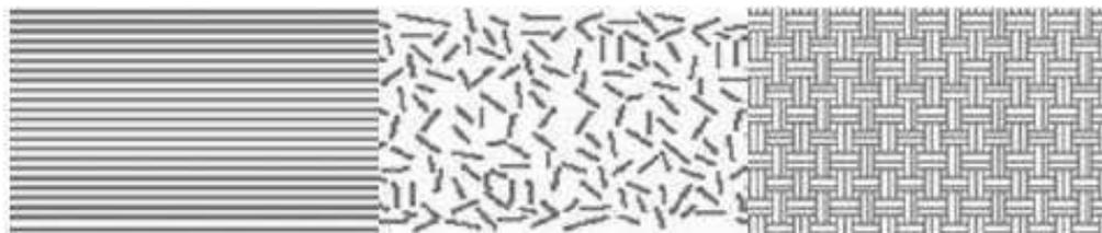
Figura 7 - Classificação segundo a fase constituinte descontínua. Nascimento et al (2009).
