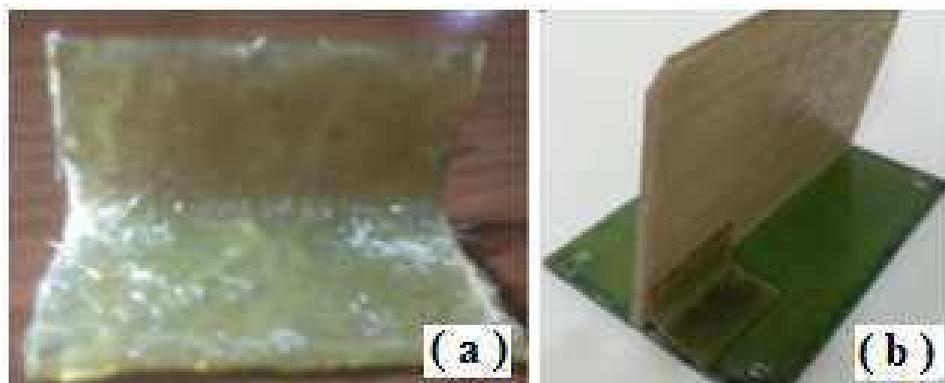
Figura 102 – Perfil Estrutural I (a) e sua disposição como elemento estrutural (b).
