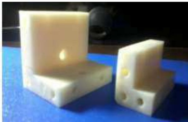
Figura 73 - Formatos em L do molde produzidos com a tecnologia de prototipagem rápida.
