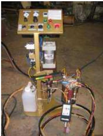
O equipamento consiste numa estação de processamento onde podemos encontrar ajuste da razão de catalisador, recipiente de armazenamento para resina e catalisador, regulador das pressões de injeção e da pressão do motor pneumático, este último leva a resina através de um conjunto de mangueiras, válvulas e conexões até o bico de injeção que realiza a mistura entre a resina e o catalisador na proporção pré-programada inicialmente.
