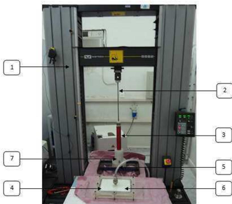
Figura 49 - Equipamento para processamento por RTM.
