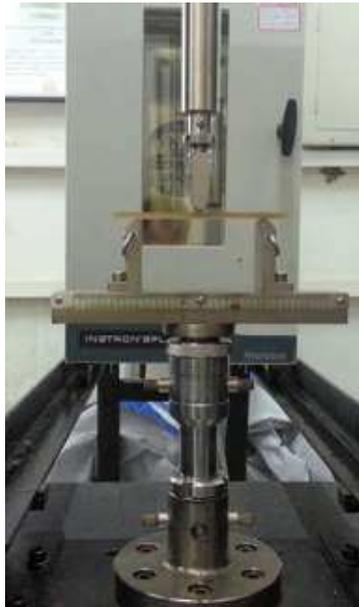
Figura 33 – Ensaio de flexão em 3 pontos.
