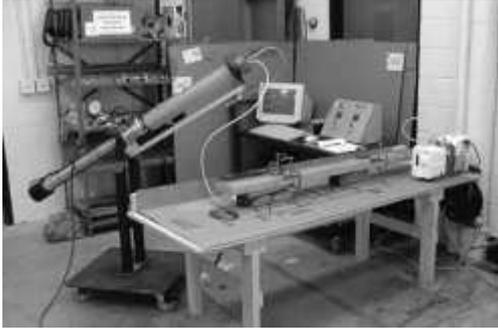
semelhante a uma grande seringa que injeta em um só ciclo, toda a resina existente no reservatório. A injeção se dá através de um longo cilindro pneumático acoplado a um servopistão, onde por meio de controles alternados podem-se controlar a extensão, retração e a localização do pistão.
