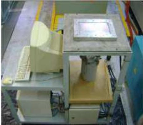
Neste equipamento consta de um computador instalado em conjunto a um sistema de aquisição de dados para que assim possa verificar a temperatura e a pressão do processo de injeção. O sistema de injeção tipo vaso de pressão que está situado abaixo do molde serve para que assim o caminho da resina até a cavidade possa seja minimizado. O equipamento é abrigado em uma estrutura feita de perfis metálicos, possuindo rodízios em sua base.
