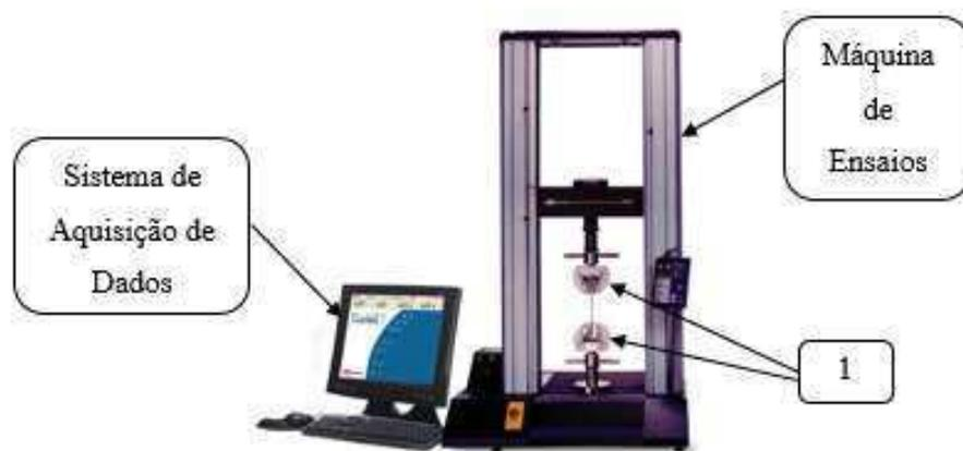
Figura 43 - Sistema de testes universal INSTRON 5582.
