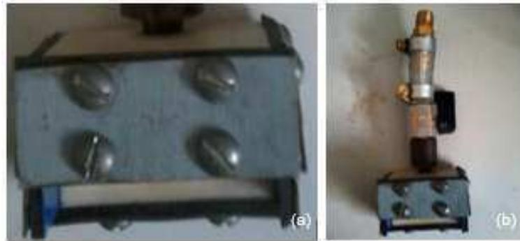
Figura 74 - (a) Molde montado; (b) Molde com bico injetor.
