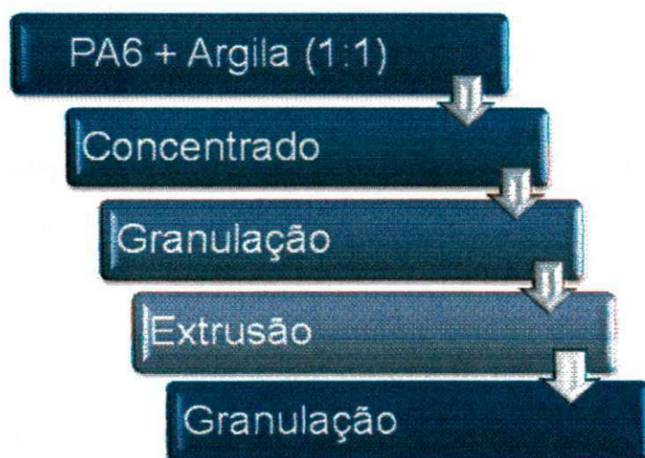
Figura 15: Fluxograma da preparação dos nanocompósitos de poliamida 6/argila.
