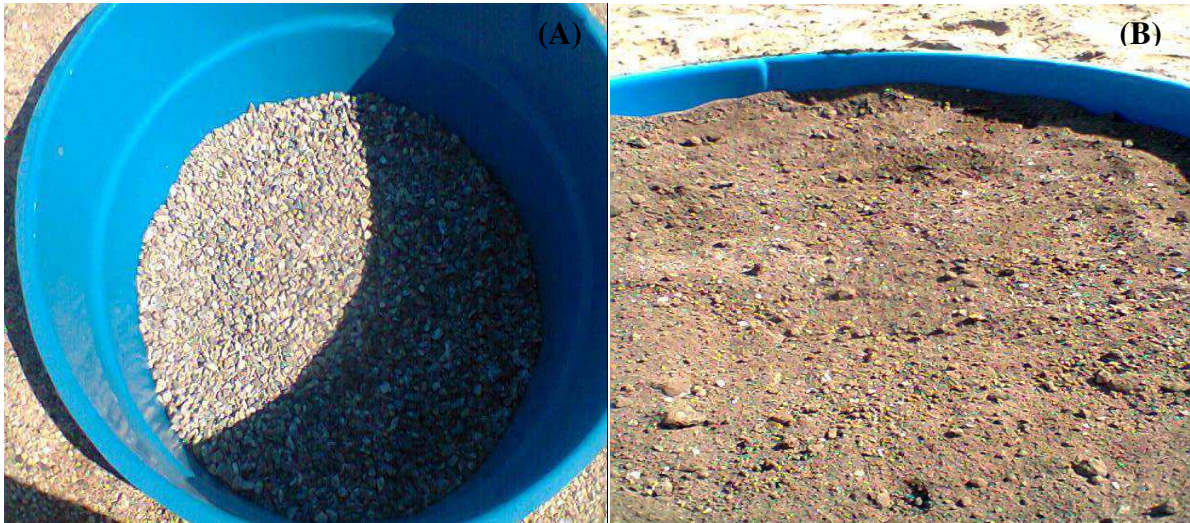
Figura 2. Preenchimento da camada de brita (A), preenchimento com solo (B).
