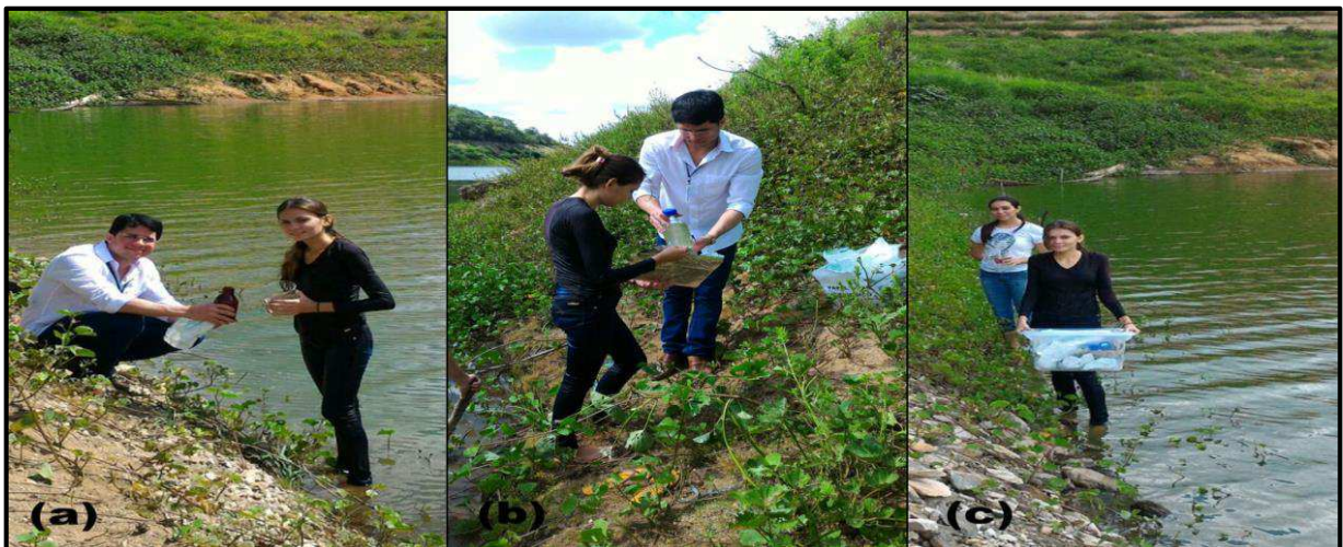
Figura 3: (a) Processo de armazenamento em frasco; (b) Processo de etiquetagem; (c) Processo de transferência para laboratório.
