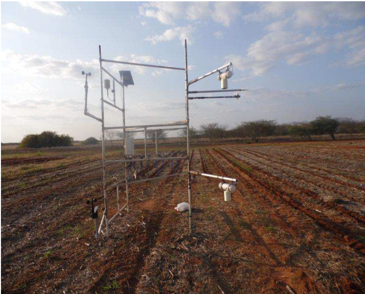
Figura 3.2 – Torre micrometeorológica com visualização dos sensores instalados
