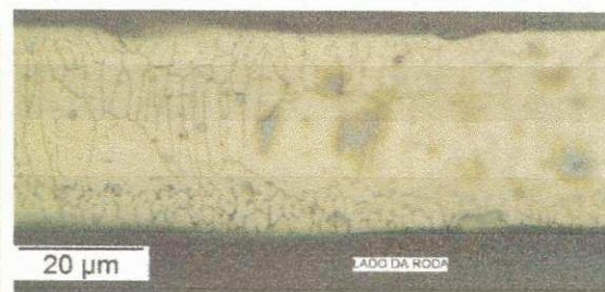
Figura 25. Microscopia ótica das fitas da liga VIM 40 na velocidade de: a) 30 m/s; b) 40 m/s e c) 50 m/s.
