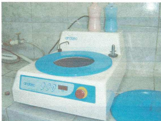
Figura 14. Máquina politriz ,modelo Arapol E, fabricante Arotec.
