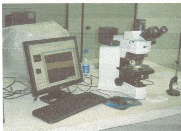
Figura 15. Microscópio Olympus modelo BX51.
