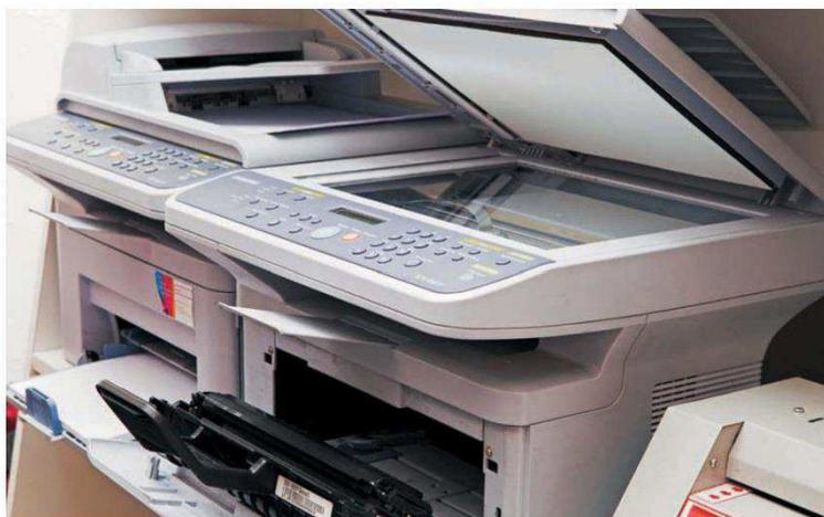
Máquinas fotocopadoras monocromáticas. Na máquina da direita o painel frontal está aberto mostrando o cartucho que armazena o *toner*.
