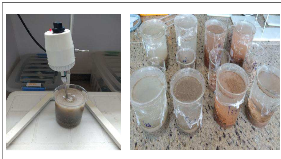
Figura 75 – Agitação inicial do meio e repouso das amostras
