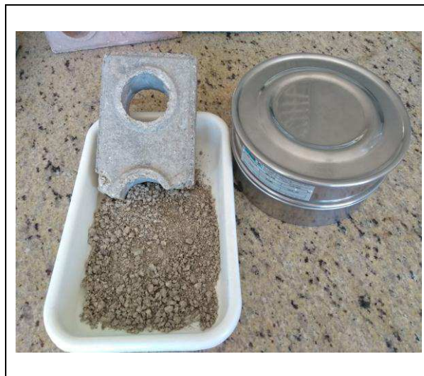
Figura 73 - Trituração dos blocos
